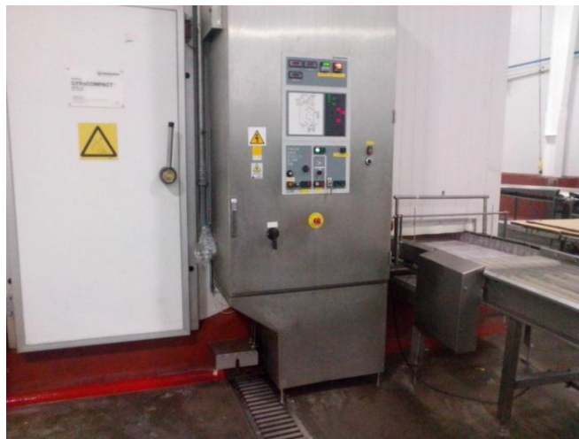
Figura 9. Túnel de congelado
