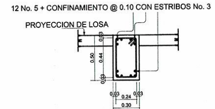
VIGA TIPO V-2 CORTE B-B' ESC. 1/15
