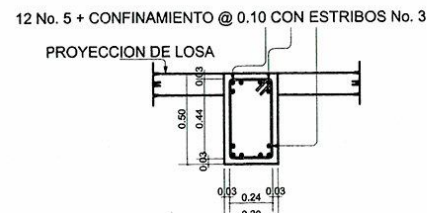
VIGA TIPO V-2 CORTE A-A' ESC. 1/15
