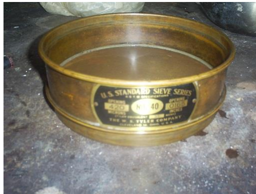
Figura 18. Tamiz no.40 para filtrar sulfato
