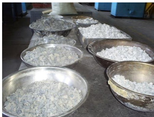
Figura 6. Bandejas con agregado grueso basalto y caliza
