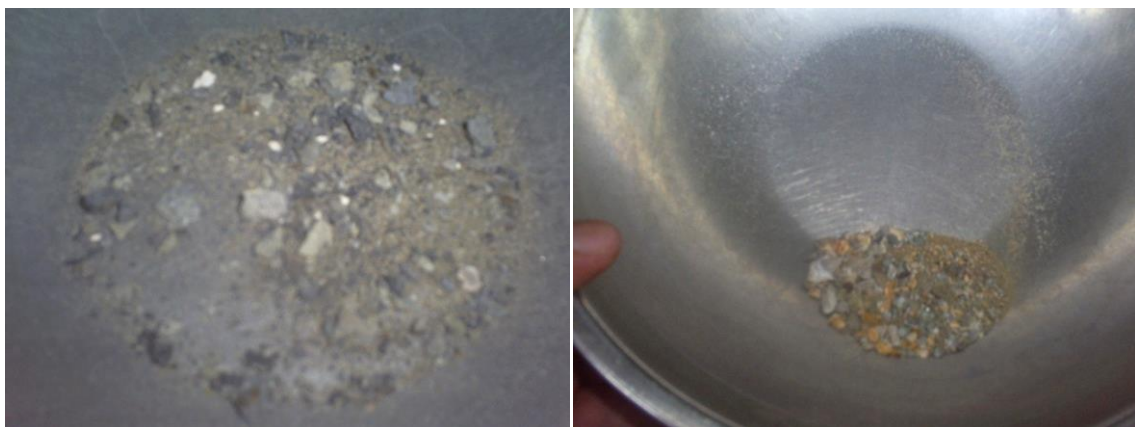
Figura 35. Disgregación de C.5, 90 horas de inmersión en sulfato de sodio
