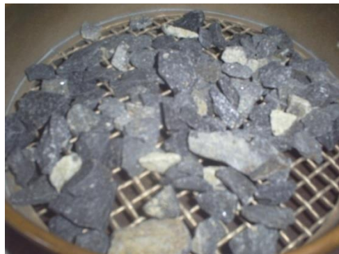
Figura 26. Tamizar cápsula II en tamiz 5/16 de pulgada
