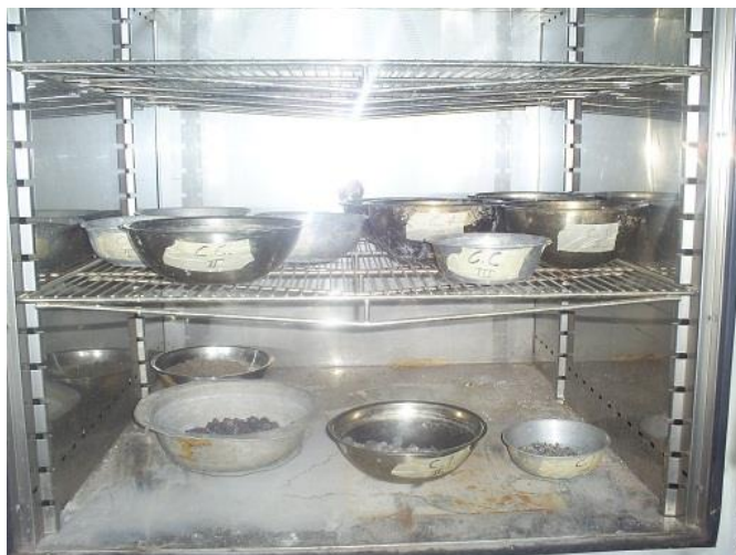
Figura 22. Cápsulas dentro de horno después del filtrado
