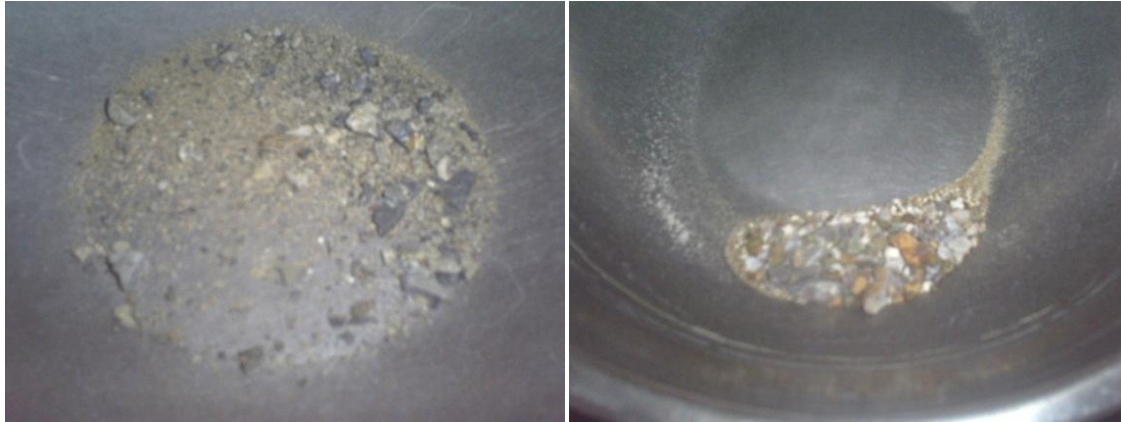
Figura 36. Disgregación de C.C, 90 horas de inmersión en sulfato de sodio
