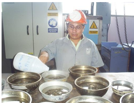
Figura 14. Vertido de sulfato en cápsulas de material
