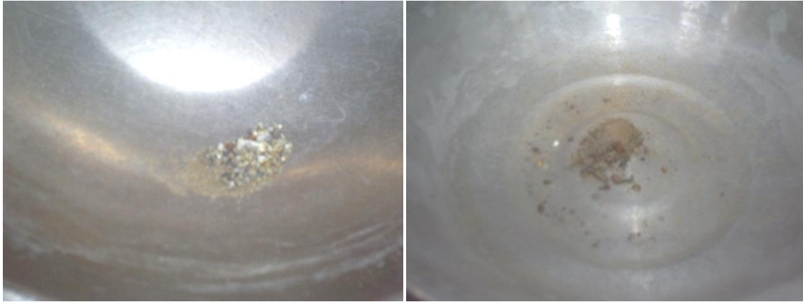
Figura 32. Disgregación de C.2, 36 horas de inmersión en sulfato de sodio
