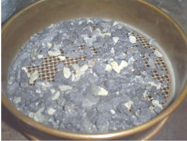
Figura 27. Tamizar cápsula III en tamiz no. 5
