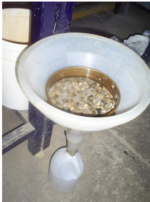
Figura 20. Procedimiento de filtrado de sulfato de sodio
