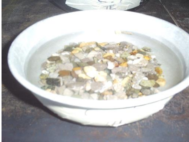
Figura 15. Material inmerso en sulfato de sodio
