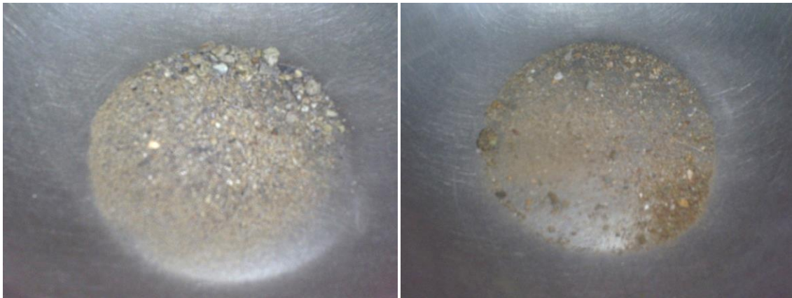
Figura 33. Disgregación de C.2, 36 horas de inmersión en sulfato de sodio
