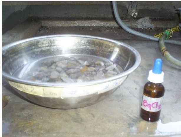
Figura 23. Aplicación de cloruro de bario
