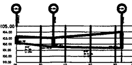
PERFIL DE PV-26.2 A PV-26 ESCALA : 1:1000
