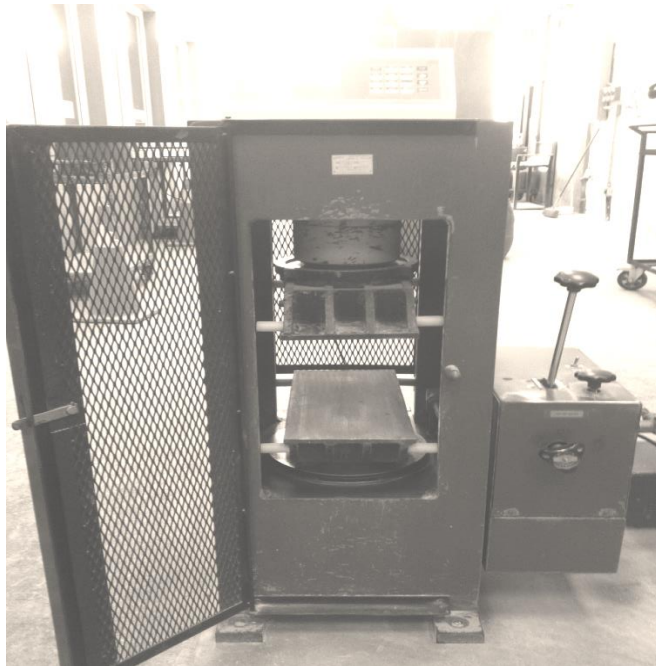
Figura 16. Máquina para comprimir bloques de concreto
