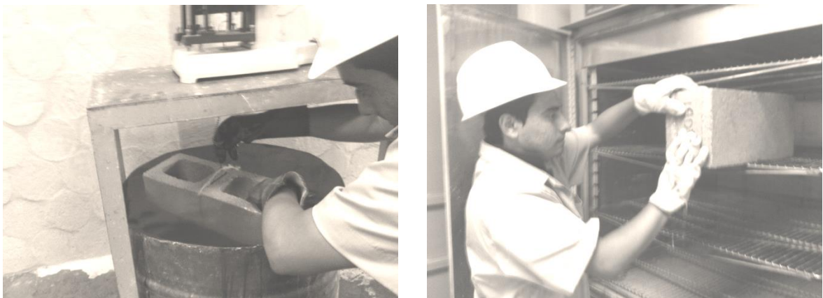
Figura 12. Determinación de la masa suspendida y sumergida, secado de bloques en horno
