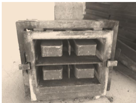
Figura 7. Molde metálico para block de 15 x 20 x 40 (cm)
