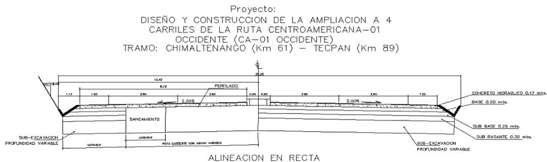
Fuente: elaboración propia para ilustrar las capas de la estructura del pavimento, utilizando el programa civil 3D.
