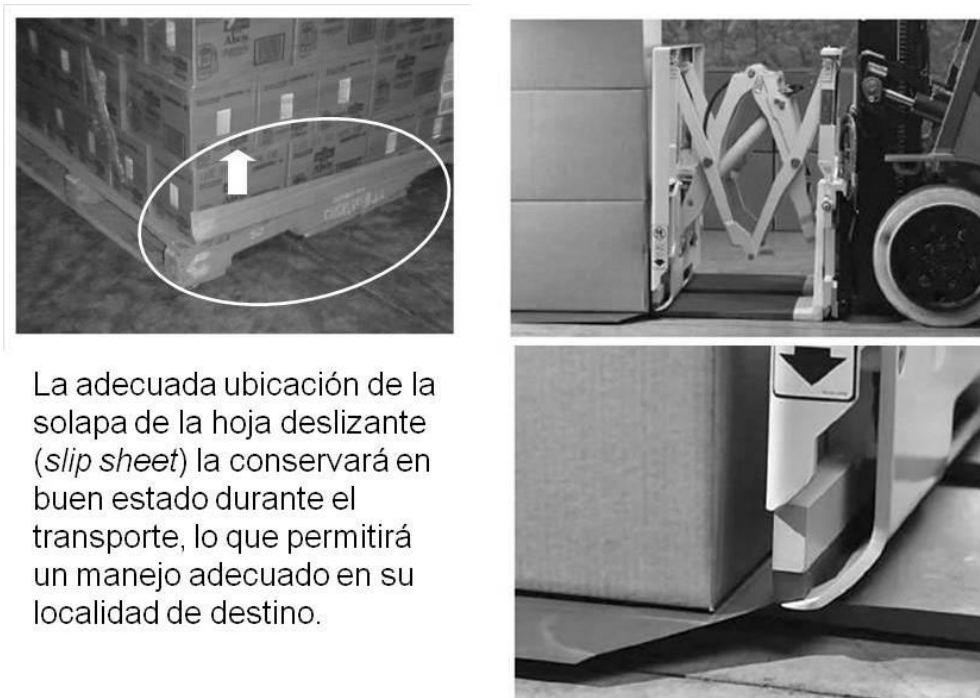
Figura 27. Posición correcta de la solapa de la hoja deslizante
