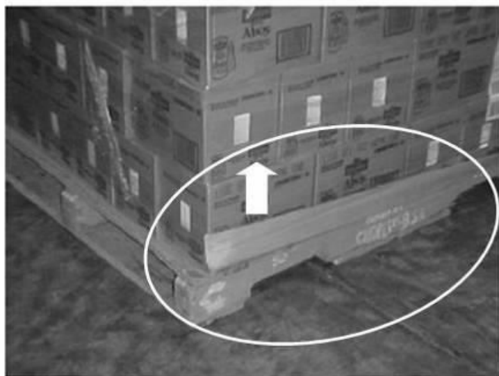
Figura 12. Posición correcta de la pestaña del slip sheet
