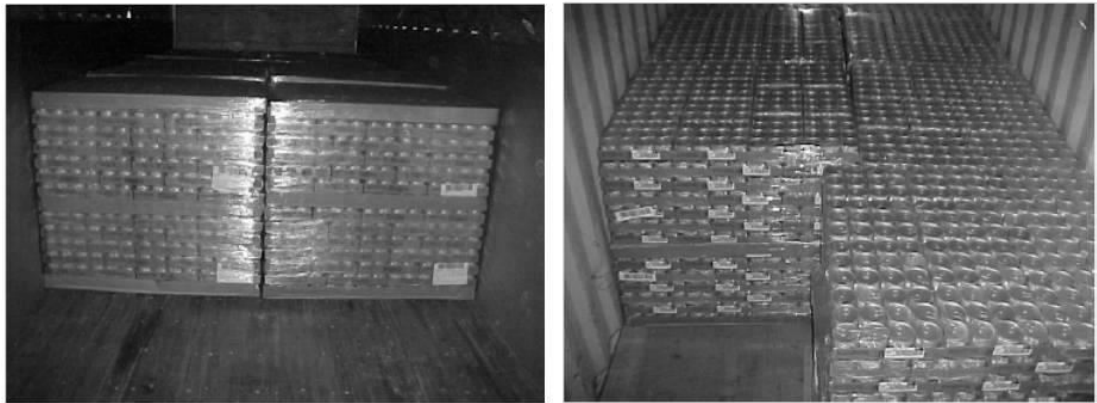
Pallets cargados paralelamente
