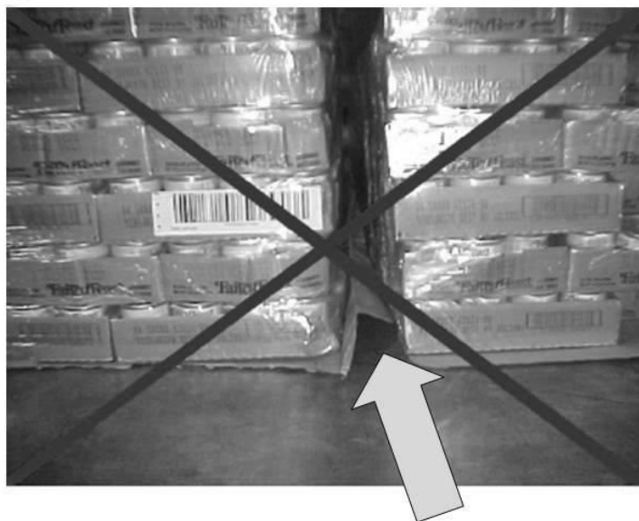
Figura 30. Muestra de solapa fracturada en un pallet
