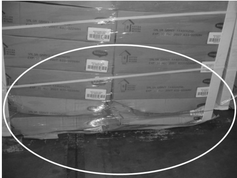
Figura 20. Caja colapsada por sobrecarga
