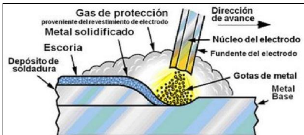
Figura 30. Soldadura de arco eléctrico
