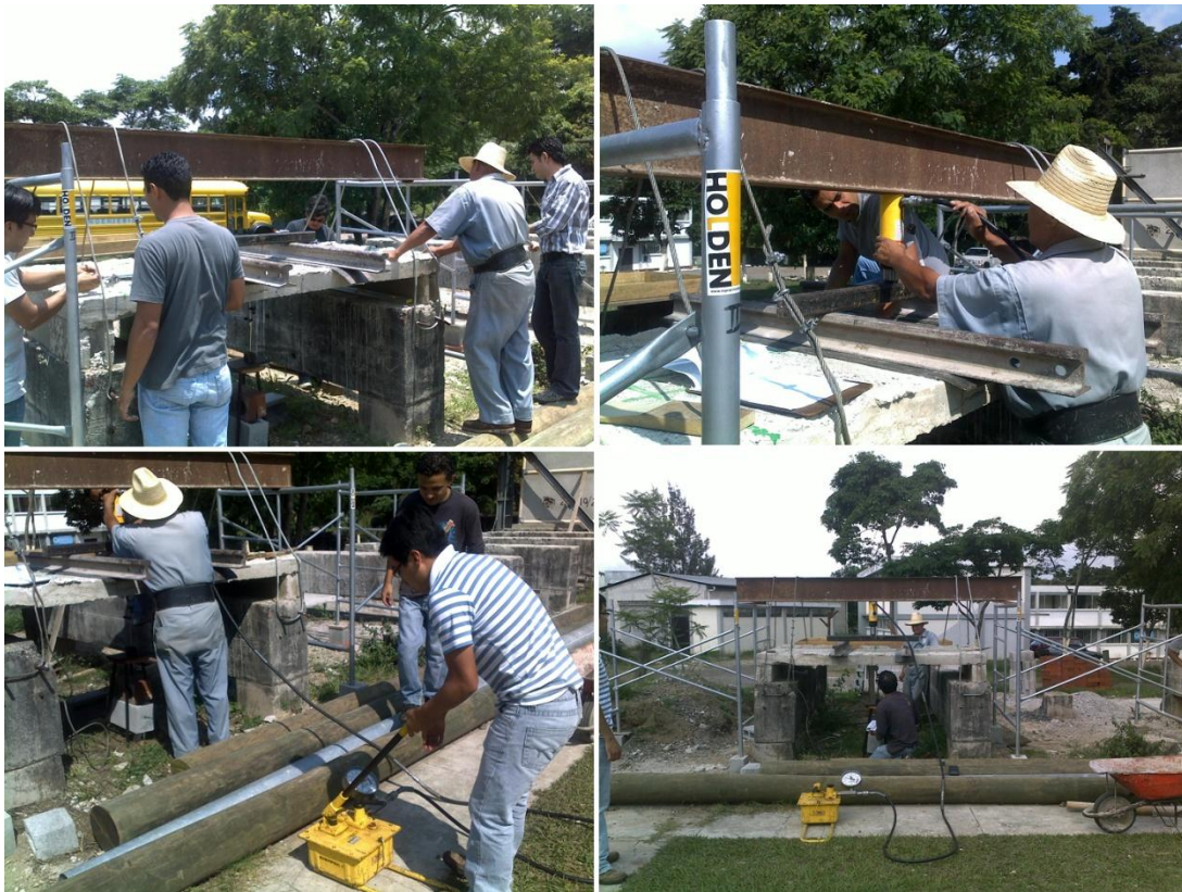
Figura 35. Modo de ensayo a flexión a tercios de tramo total
