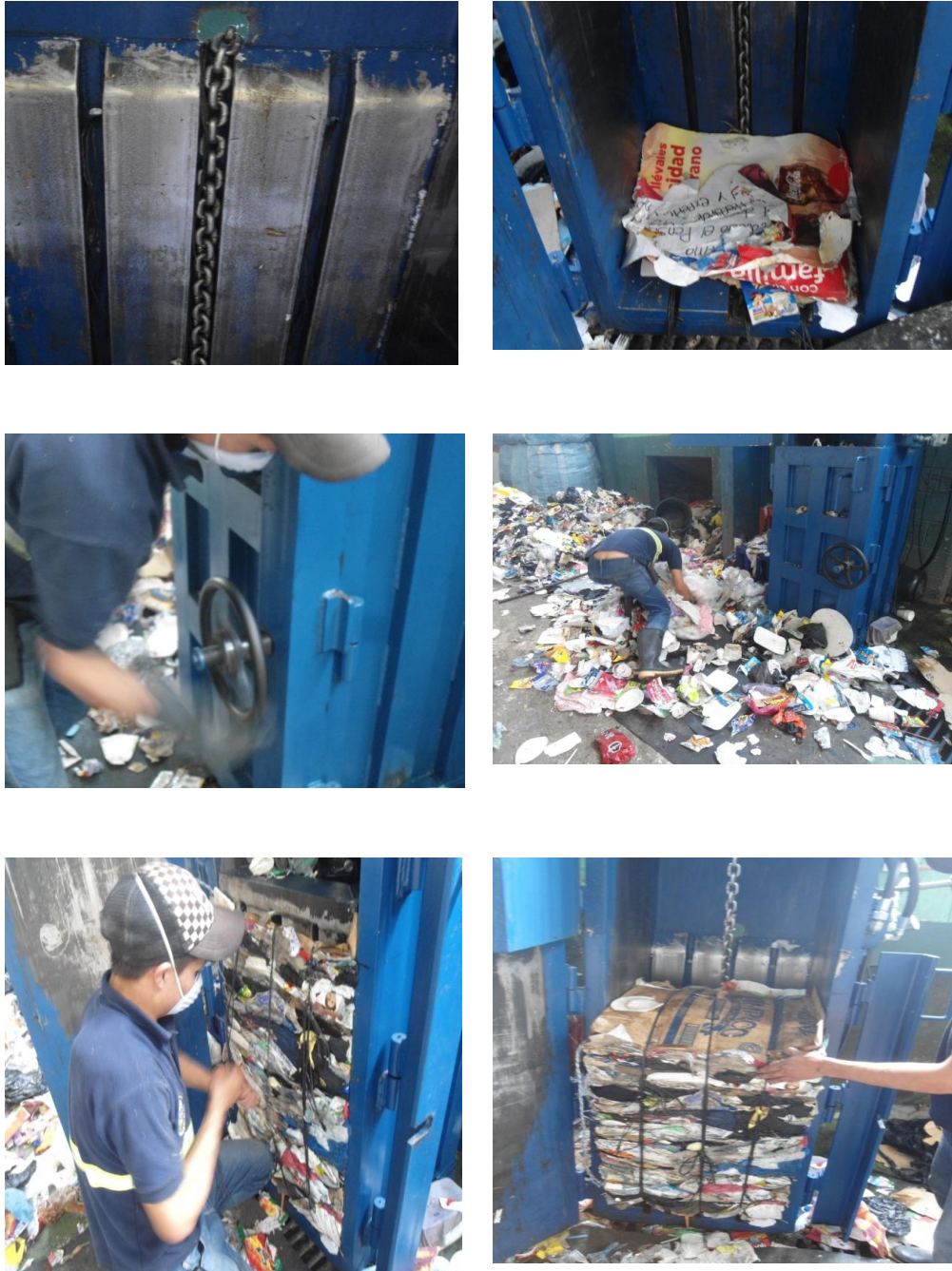
Figura 57. Proceso de compactación de residuos inorgánicos secos
