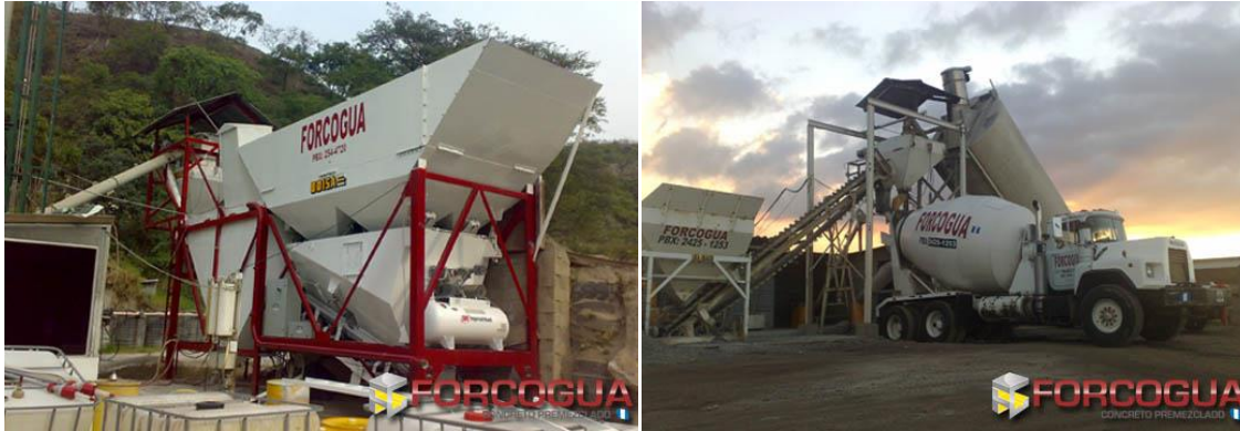
Figura 14. Sistema de manejo, almacenamiento y dosificación de agregados
