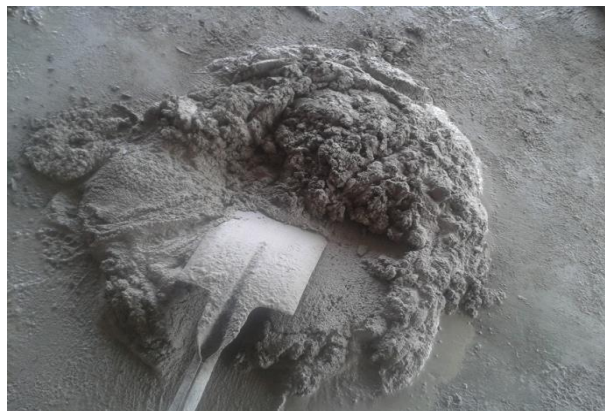
Figura 7. Mortero en estado plástico que mantiene las propiedades ideales de apariencia y color
