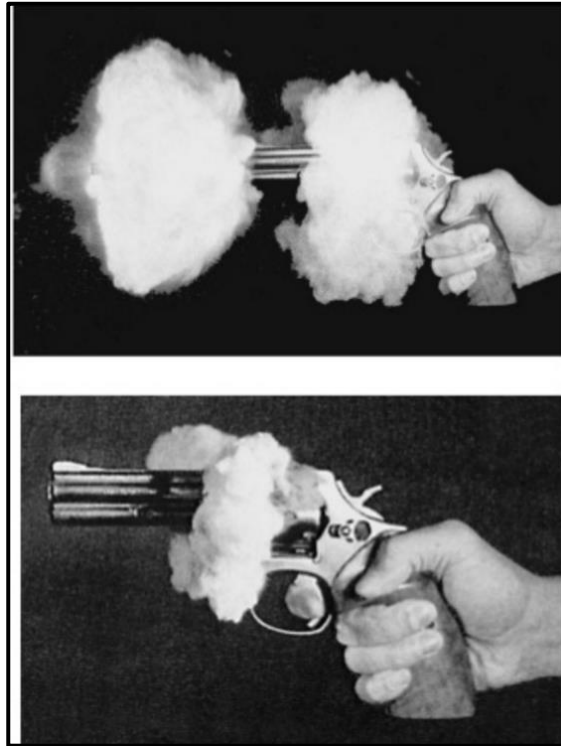
Figura 16. Producción de gases al detonar un arma de fuego
