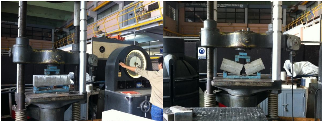
Figura 26. Ensayo a flexión de vigas
