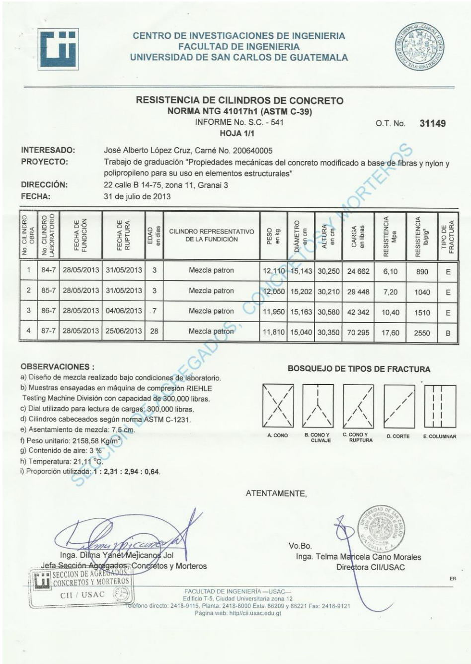
Figura 37. Resultados de ensayos a compresión de cilindros de mezcla patrón
