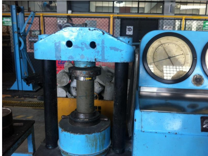
Figura 24. Ensayo a compresión
