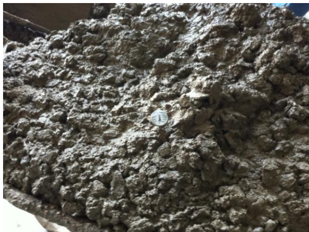
Figura 10. Prueba de temperatura del concreto
