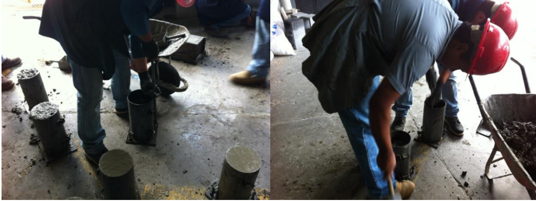
Figura 17. Llenado de especímenes
