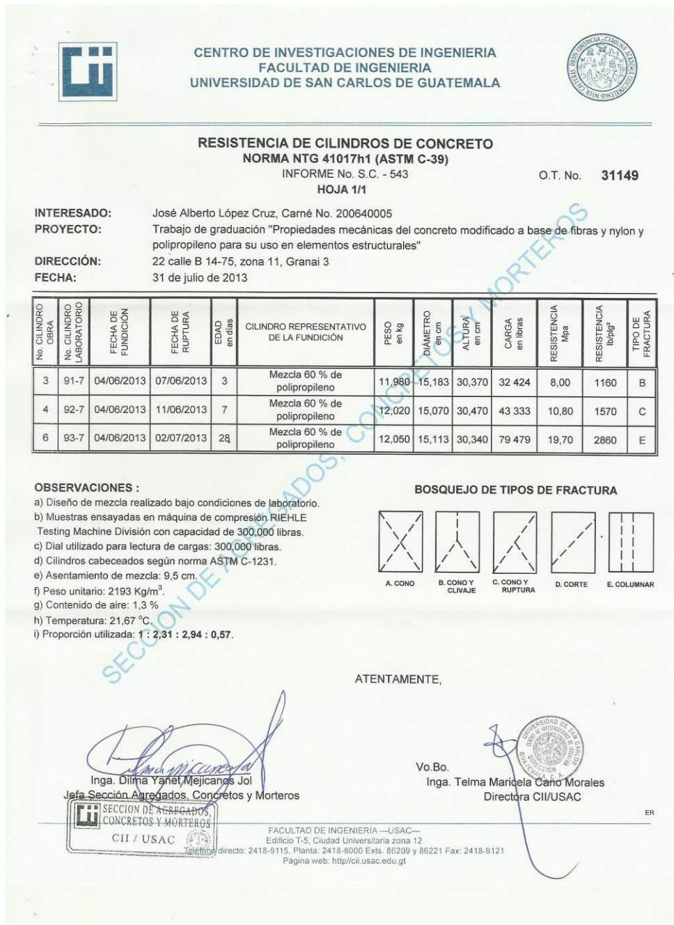
Figura 39. Resultados de ensayos a compresión de cilindros de mezcla con 60% de fibra de polipropileno
