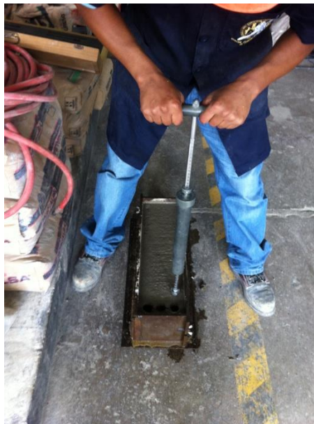
Figura 16. Penetración del mortero a diferentes intervalos de tiempo
