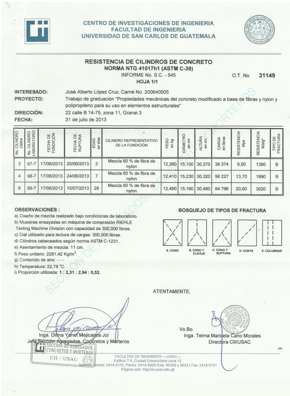
Figura 41. Resultados de ensayos a compresión de cilindros de mezcla con 60% de fibra de nylon
