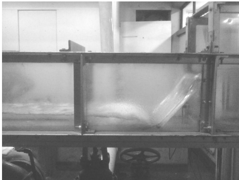
Figura 48. Ensayos de laboratorio de cuenco USBR II
