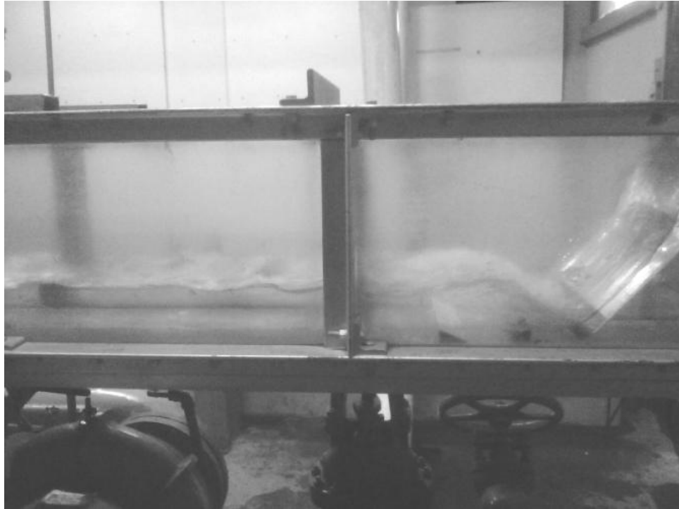
Figura 53. Resalto estable de cuenco USBR III
