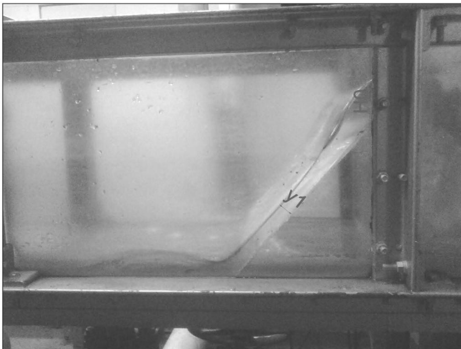
Figura 28. Ensayo de rápida con pendiente 0.9:1
