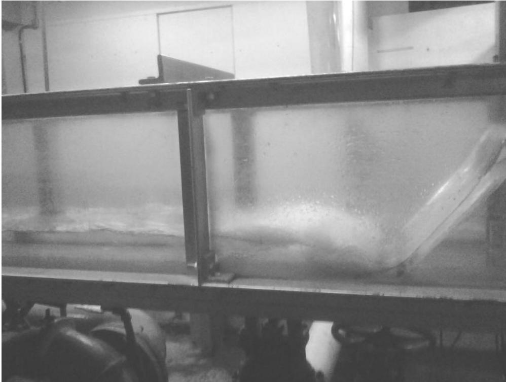
Figura 49. Resalto estable de cuenco USBR II
