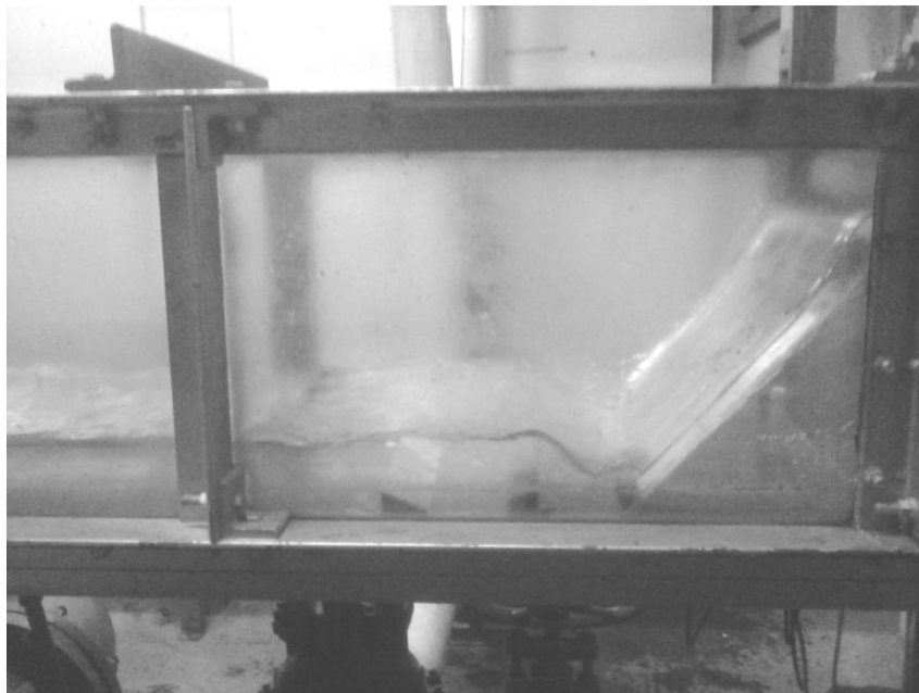
Figura 52. Ensayos de laboratorio de cuenco USBR III
