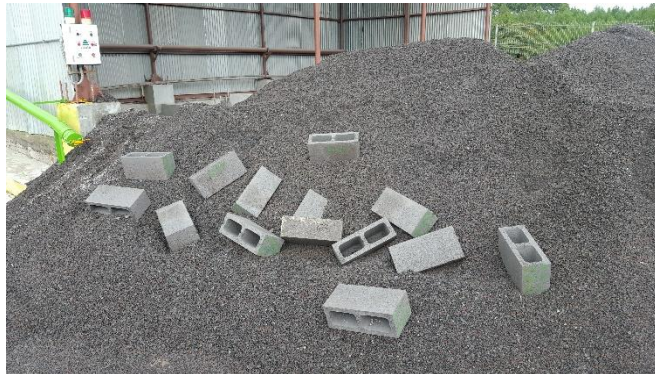
Figura 17. Inspección visual, planta Kotic 3, falta de control de muestras por parte de control de calidad
