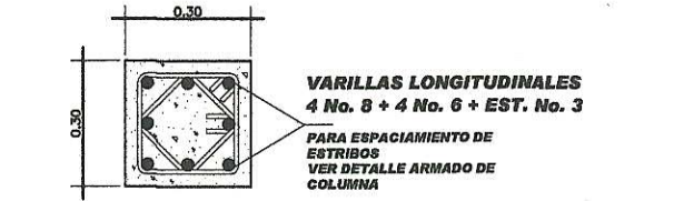
DETALLE COLUMNA C-1 ESCALA. 1:20
