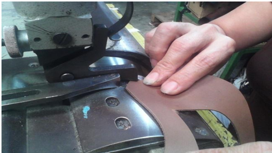
Figura 16. Proceso de desbastado
