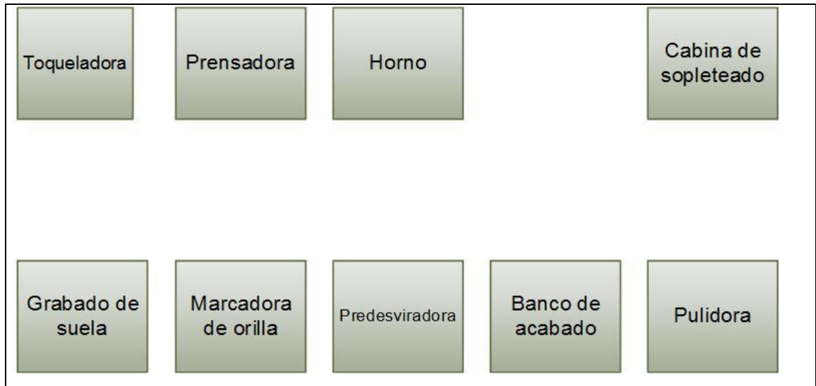
Figura 38. Diagrama de redistribución de maquinaria en área de suelas
