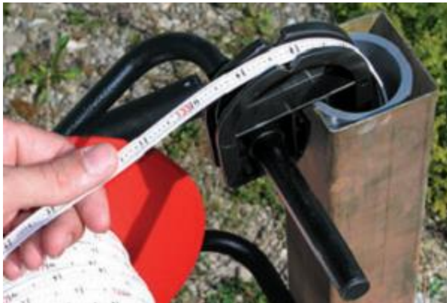
Figura 10. Introducción de sonda eléctrica en el ducto de medición
