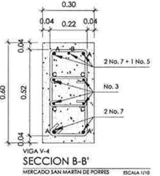
VIGA V-4 SECCION B-B' MERCADO SAN MARTIN DE PORRES ESCALA 1/10
