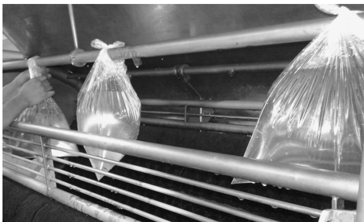
Figura 9. Medición de caudal en espreas de la peladora
