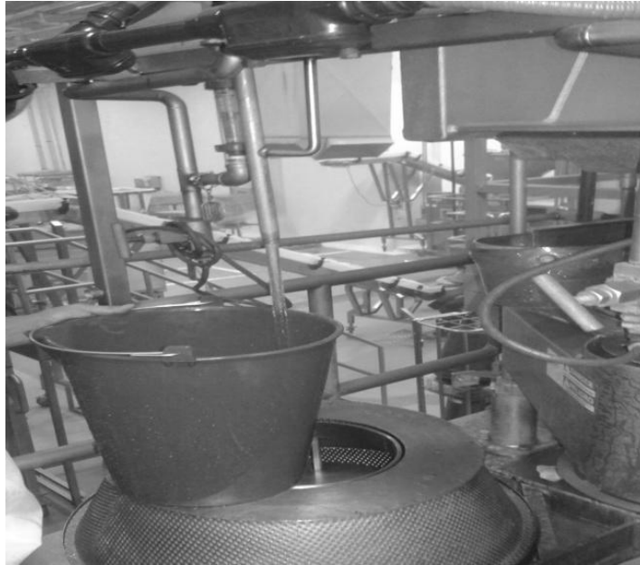
Figura 12. Medición de caudal en rebanadoras
