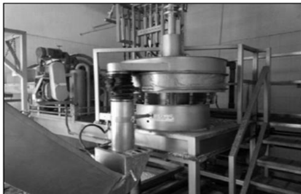
Figura 18. Recuperador de almidón
