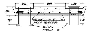
SECCIÓN C-C POZO DE VISITA ESCALA: 1:10
