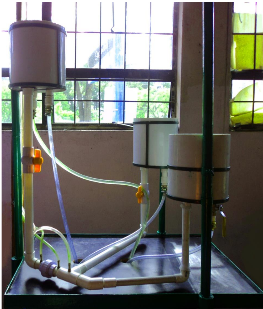
Figura 26. Circuito de tuberías ramificadas
