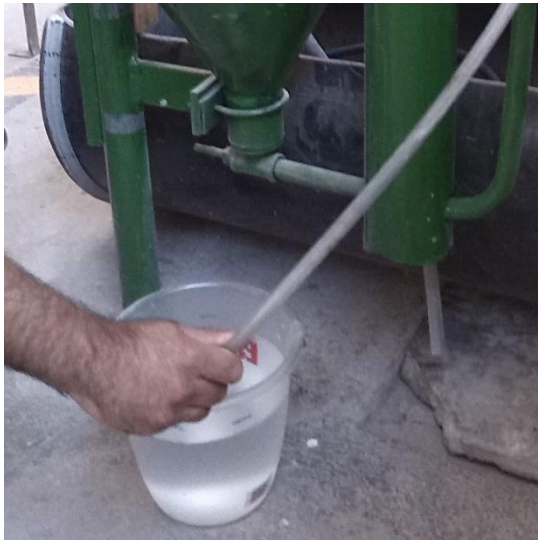
Figura 51. Aforo volumétrico en el sistema ramificado
