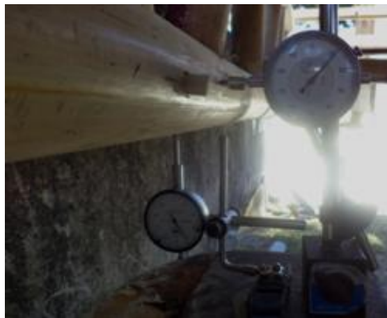
Figura 33. Posición de deformómetros dentro del sistema
