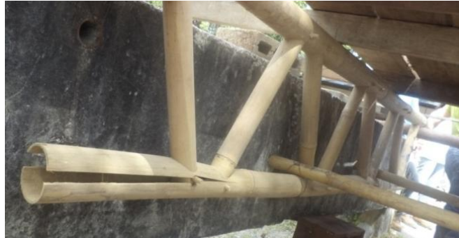
Figura 70. Falla por tensión perpendicular en JB – C3
