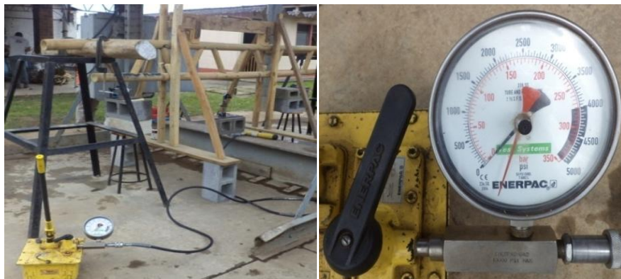
Figura 29. Medidor hidráulico de presión
