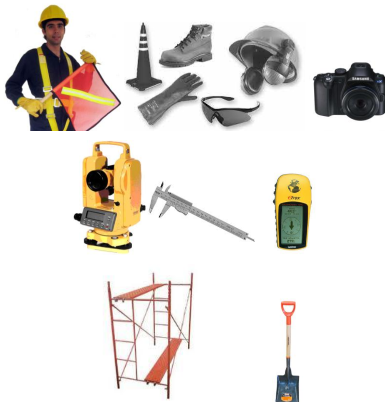
Figura 57. Equipo para realizar inspección
