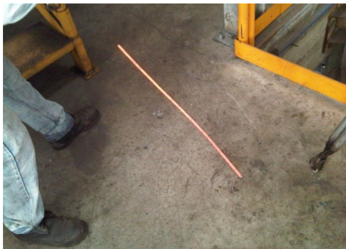
Figura 40. Barra sacada del horno de laminado después del aumento de temperatura
