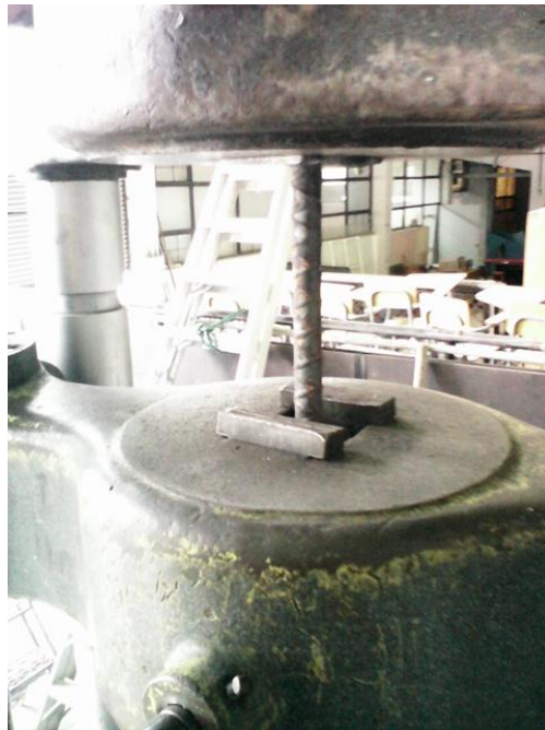
Figura 23. Barra en máquina universal para ensayo de tensión
