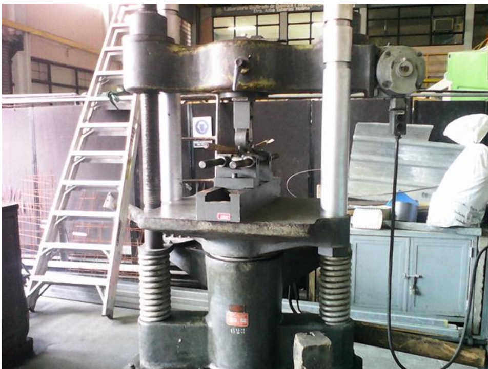
Figura 25. Ensayo de doblado en las barras de en máquina universal
