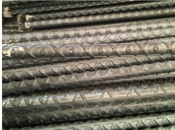
Figura 5. Marcado en barras de acero
