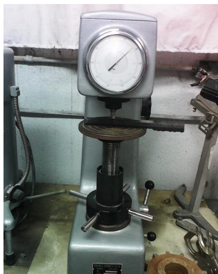
Figura 28. Durómetro Rockwell aplicando carga sobre barra
