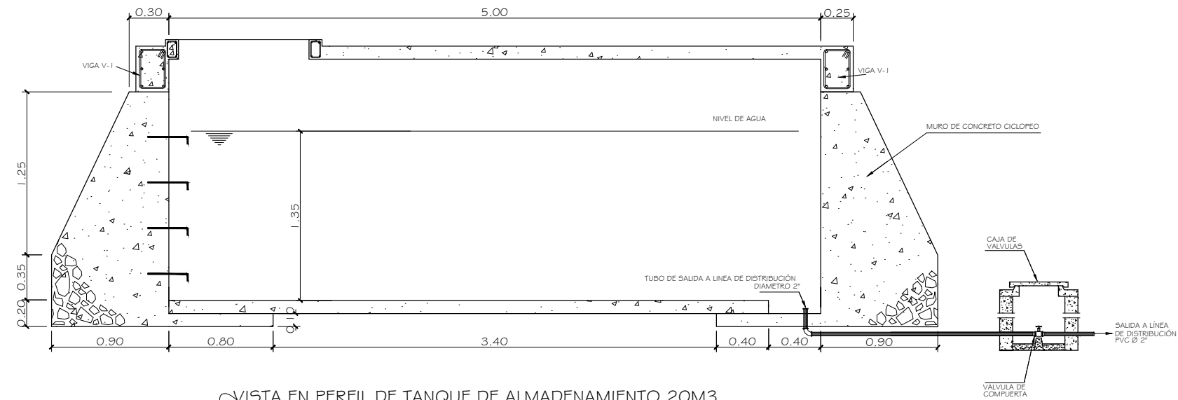
VISTA EN PERFIL DE TANQUE DE ALMADENAMIENTO 20M3 INTRODUCCIÓN DE AGUA POTABLE ALDEA NUEVO SAN JOSÉ, MORALES, IZABAL ESCALA 1:50
