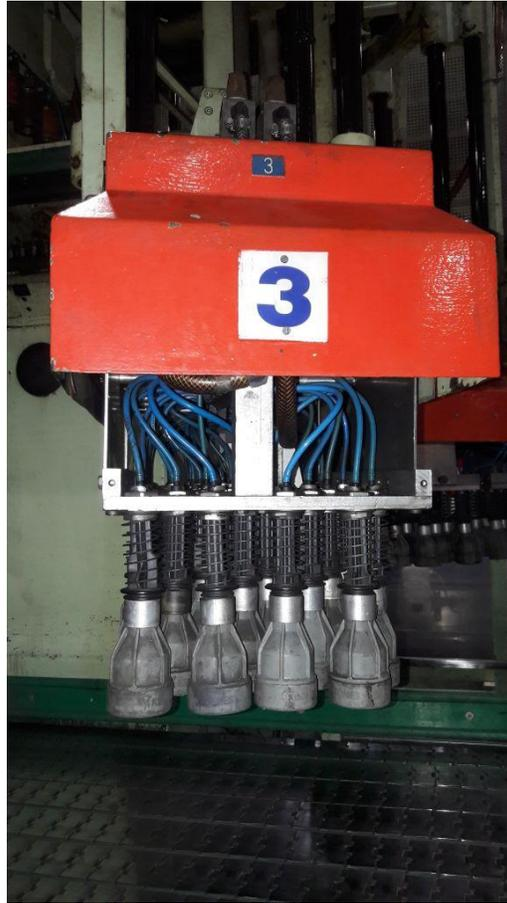
Fuente: Embotelladora la Mariposa. Cabezal de agarre para encajonadora *smart pack* de *krones*. p. 22.
