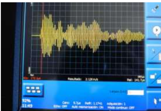
Figura 16: Comportamiento presentado por la onda en pantalla para el palpador de 24 KHz con una ganancia de 1 sobre el patrón 1 en los puntos (5,5) y (35,5). Zona de material uniforme.
