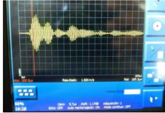
Figura 47 Comportamiento presentado por la onda en pantalla para el palpador de 24 KHz con una ganancia de 1 sobre el patrón 2 en los puntos (35, 15) y (5, 15). Zona de material con defectología
