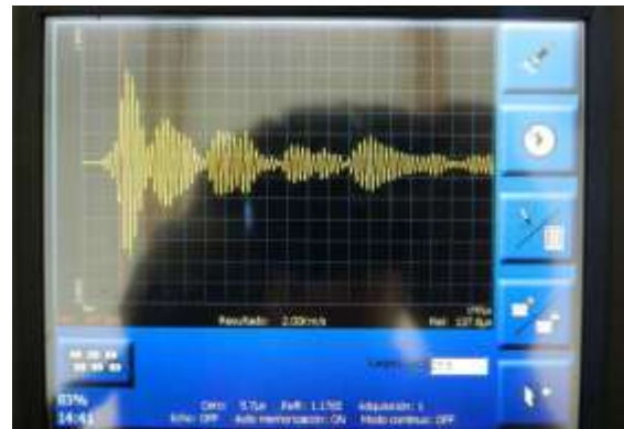
Figura 72: Comportamiento presentado por la onda en pantalla para el palpador de 24 KHz con una ganancia de 1 sobre el patrón 5 en los puntos (62.5, 40) y (35, 40). Zona de material uniforme.
