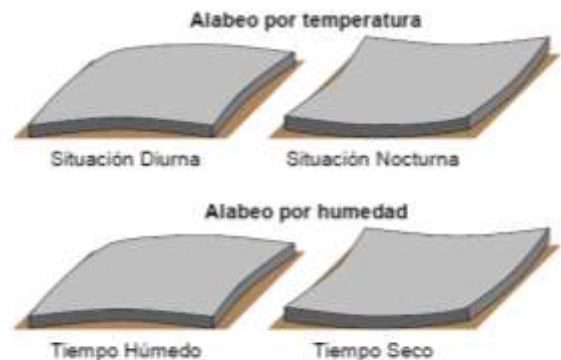
Figura 35: Tipos de alabeo. Jornada de actualización técnica "Diseño y Construcción de pavimentos de Hormigón" Ing. Diego H. Calo, 20 de noviembre de 2008.
