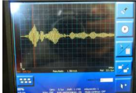
Figura 35: Comportamiento presentado por la onda en pantalla para el palpador de 24 KHz con una ganancia de 1 sobre el patrón 6 en los puntos (5, 5) y (35, 5). Zona de material con presencia de defectología.
