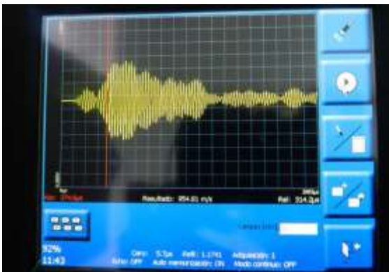
Figura 15: Comportamiento presentado por la onda en pantalla para el palpador de 24 KHz con una ganancia de 1 sobre el patrón 2 en los puntos (5,25) y (35,5). Zona de material con presencia de defectología.
