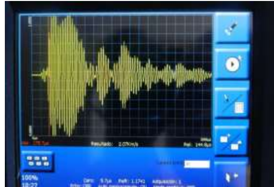
Figura 5: Comportamiento presentado por la onda en pantalla para el palpador de 24 KHz con una ganancia de 1 sobre el patrón 4 en los puntos (40,17.5) y (40,17.5). Zona de material uniforme.
