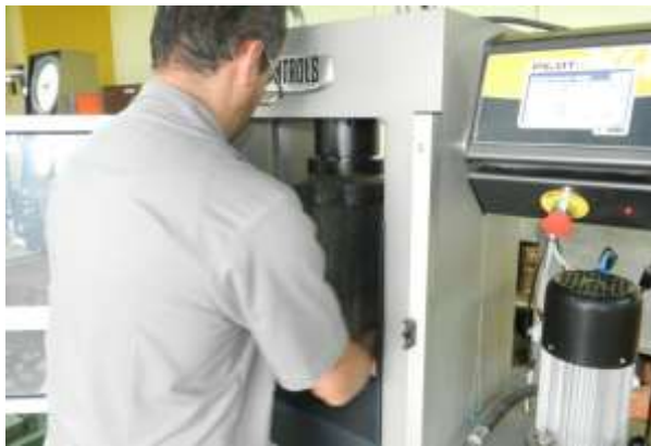
Figura 41: Ensayo de compresión de cilindros después de transcurrido el tiempo de curado.
