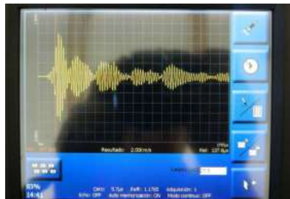
Figura 31: Comportamiento presentado por la onda en pantalla para el palpador de 24 KHz con una ganancia de 1 sobre el patrón 5 en los puntos (62.5, 10) y (35, 40). Zona de material uniforme.
