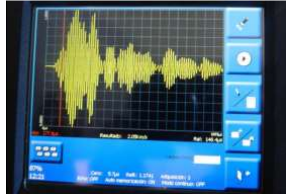
Figura 23 Comportamiento presentado por la onda en pantalla para el palpador de 24 KHz con una ganancia de 1 sobre el patrón 3 en los puntos (10,3.25) y (40,32.5). Zona de material uniforme.
