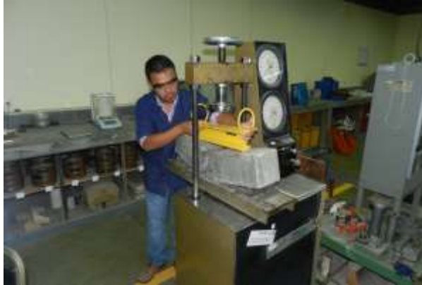
Figura 40: Ensayo de flexión realizado a la viga después de transcurrido el tiempo de curado.
