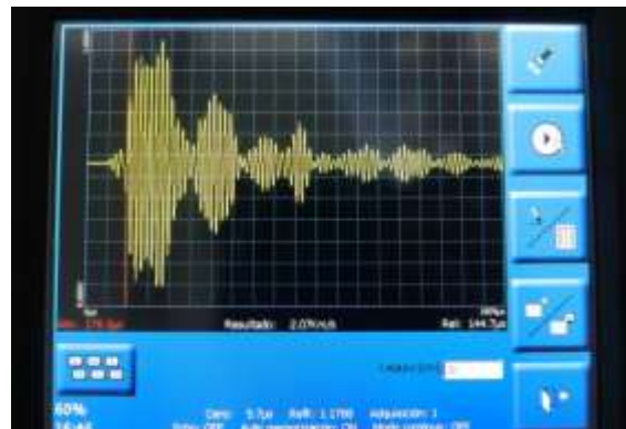
Figura 49 Comportamiento presentado por la onda en pantalla para el palpador de 24 KHz con una ganancia de 1 sobre el patrón 2 en los puntos (35, 15) y (5, 15). Zona de material uniforme.
