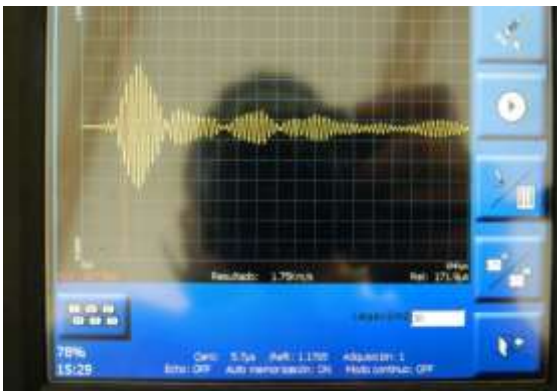
Figura 39: Comportamiento presentado por la onda en pantalla para el palpador de 24 KHz con una ganancia de 1 sobre el patrón 6 en los puntos (35, 35) y (65,35). Zona de material con presencia de defectología
