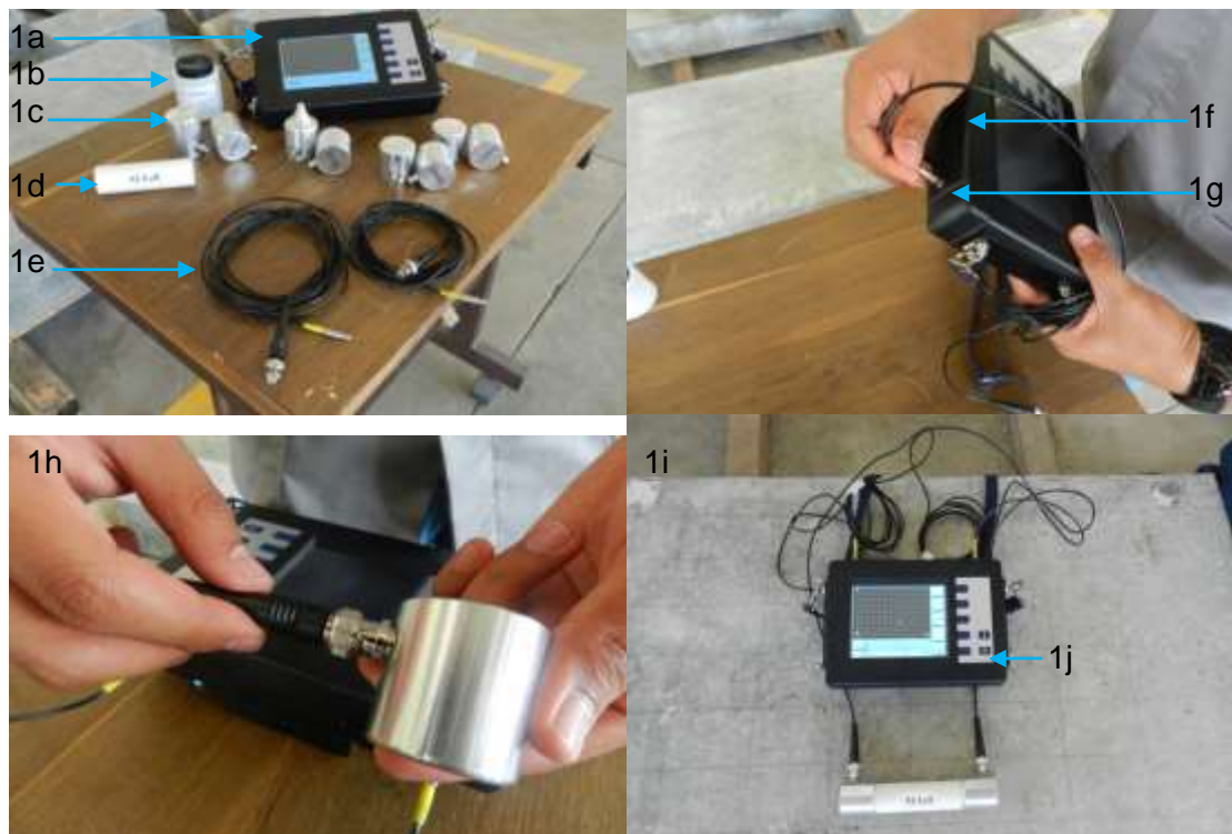
Figura 1: Imagen del equipo ultrasónico, sus partes y proceso de ensamblado del mismo.
