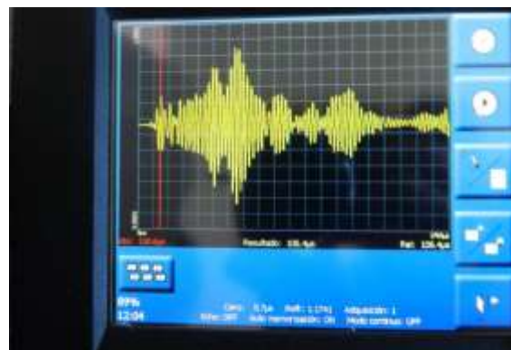
Figura 19: Comportamiento presentado por la onda en pantalla para el palpador de 24 KHz con una ganancia de 1 sobre el patrón 1 en los puntos (35, 5) y (35, 25). Zona de material con presencia de defectología.
