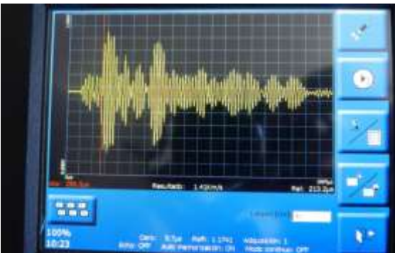
Figura 4: Comportamiento presentado por la onda en pantalla para el palpador de 24 KHz con una ganancia de 1 sobre el patrón 3 en los puntos (10,17.5) y (30,17.5). Zona de material uniforme.
