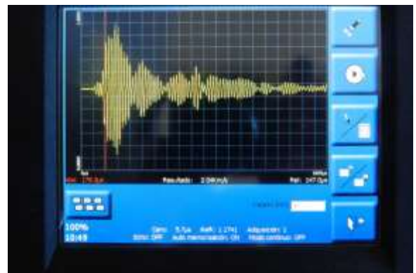
Figura 61: Comportamiento presentado por la onda en pantalla para el palpador de 24 KHz con una ganancia de 1 sobre el patrón 6 en los puntos (35,35) y (65,35). Zona de material uniforme.
