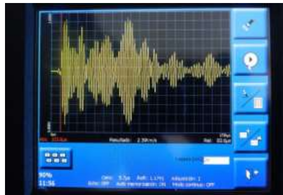
Figura 18: Comportamiento presentado por la onda en pantalla para el palpador de 24 KHz con una ganancia de 1 sobre el patrón 1 en los puntos (5, 5) y (5, 25). Zona de material uniforme.
