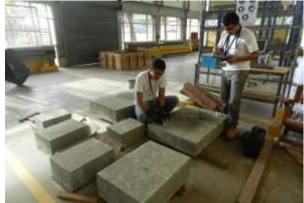
Figura 42: Evaluación de los patrones por medio del ultrasonido C372N
