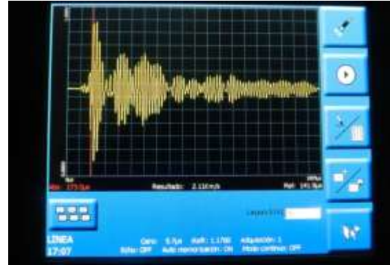
Figura 51 Comportamiento presentado por la onda en pantalla para el palpador de 24 KHz con una ganancia de 1 sobre el patrón 2 en los puntos (35, 15) y (5, 15). Zona de material uniforme.
