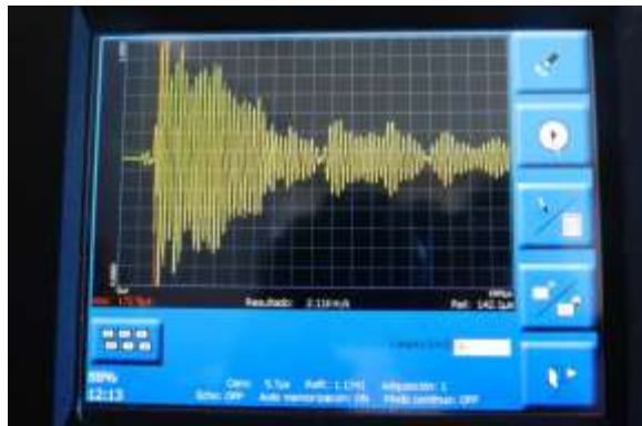
Figura 67: Comportamiento presentado por la onda en pantalla para el palpador de 24 KHz con una ganancia de 1 sobre el patrón 3 en los puntos (40,2.5) y (40,32.5). Zona de material uniforme.
