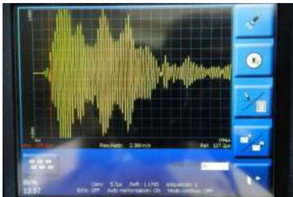
Figura 69: Comportamiento presentado por la onda en pantalla para el palpador de 24 KHz con una ganancia de 1 sobre el patrón 4 en los puntos (10, 32.5) y (40, 32.5). Zona de con presencia de defectología.
