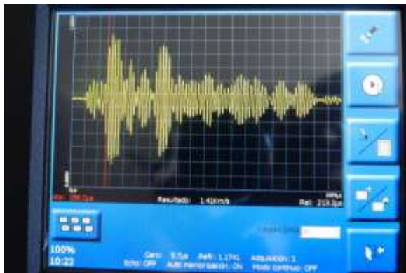
Figura 59: Comportamiento presentado por la onda en pantalla para el palpador de 24 KHz con una ganancia de 1 sobre el patrón 3 en los puntos (10,17.5) y (30,17.5). Zona de material uniforme.
