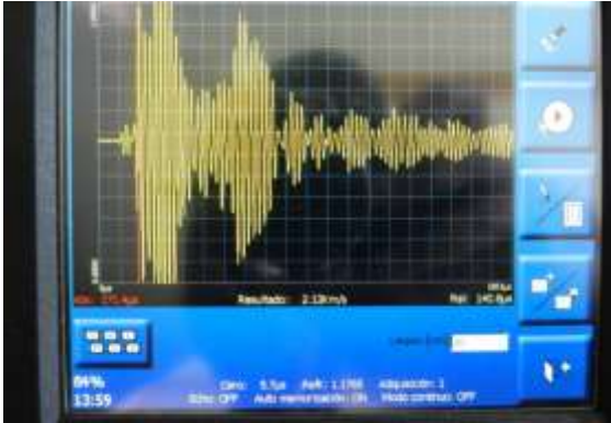
Figura 26: Comportamiento presentado por la onda en pantalla para el palpador de 24 KHz con una ganancia de 1 sobre el patrón 4 en los puntos (10,2.5) y (10,32.5). Zona de material uniforme.
