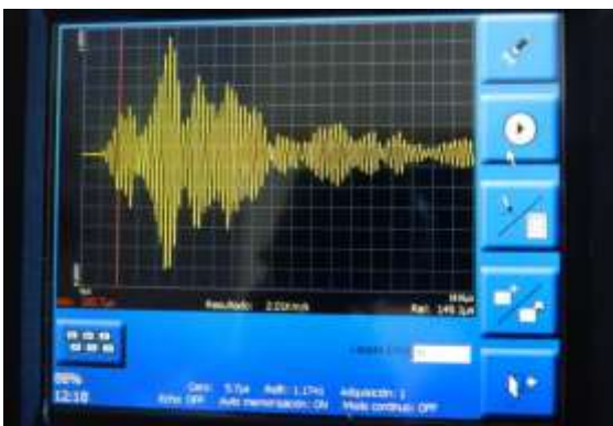
Figura 22: Comportamiento presentado por la onda en pantalla para el palpador de 24 KHz con una ganancia de 1 sobre el patrón 3 en los puntos (10,2.5) y (40,2.5). Zona de material uniforme.
