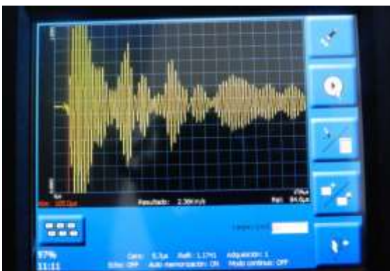
Figura 10: Comportamiento presentado por la onda en pantalla para el palpador de 24 KHz con una ganancia de 1 sobre el patrón 2 en los puntos (30,5) y (30,25). Zona de material uniforme.
