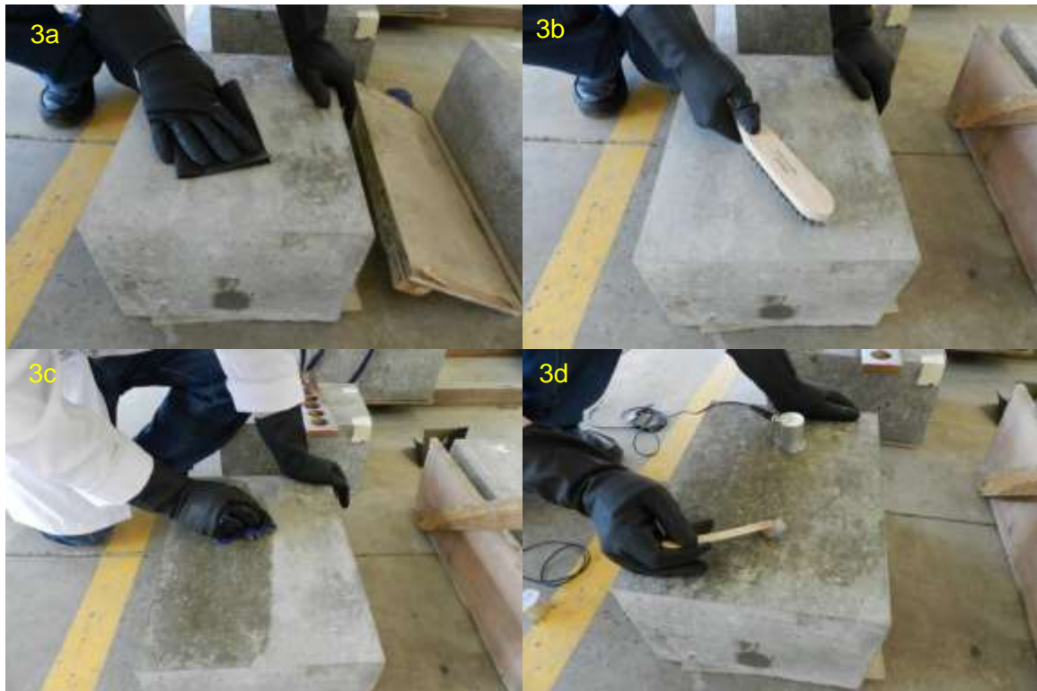
Figura 3: Procedimiento de preparación de superficies para inspección ultrasónica.
