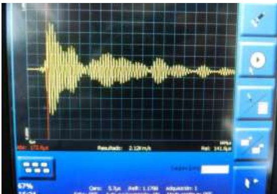
Figura 45 Comportamiento presentado por la onda en pantalla para el palpador de 24 KHz con una ganancia de 1 sobre el patrón 2 en los puntos (35, 35) y (35, 5). Zona de material uniforme.
