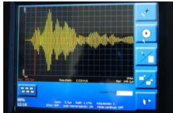
Figura 68: Comportamiento presentado por la onda en pantalla para el palpador de 24 KHz con una ganancia de 1 sobre el patrón 3 en los puntos (10,2.5) y (40,2.5). Zona de con comportamiento de onda influenciado por defectología, mas esta no aparece según la variación de la velocidad.
