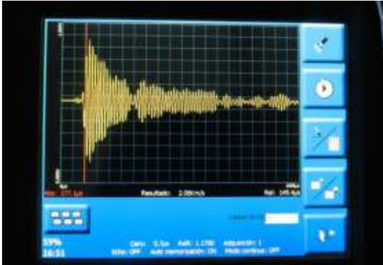
Figura 50 Comportamiento presentado por la onda en pantalla para el palpador de 24 KHz con una ganancia de 1 sobre el patrón 2 en los puntos (35, 15) y (5, 15). Zona de material uniforme.
