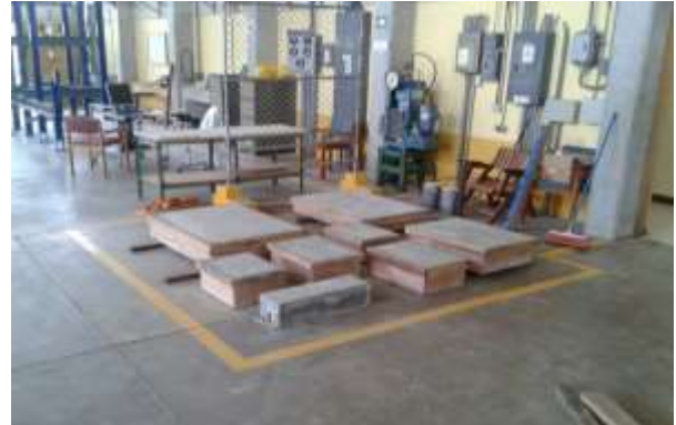
Figura 39: Patrones ubicados en el laboratorio del CIVCO durante el proceso de curado.
