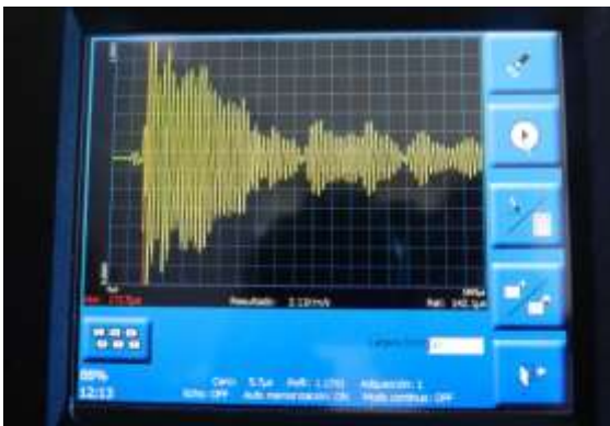
Figura 21: Comportamiento presentado por la onda en pantalla para el palpador de 24 KHz con una ganancia de 1 sobre el patrón 2 en los puntos (40,2.5) y (40,32.5). Zona de material uniforme.
