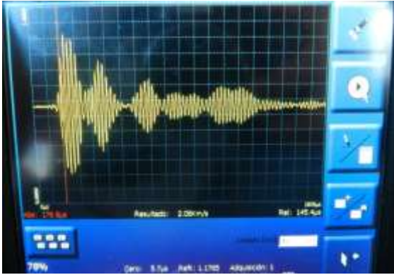
Figura 38: Comportamiento presentado por la onda en pantalla para el palpador de 24 KHz con una ganancia de 1 sobre el patrón 6 en los puntos (65, 5) y (35, 5). Zona de material uniforme.
