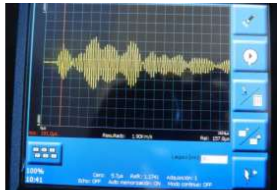
Figura 7: Comportamiento presentado por la onda en pantalla para el palpador de 24 KHz con una ganancia de 1 sobre el patrón 7 en los puntos (65,35) y (65,35). Zona de material con presencia de defectología inducida correspondiente a la simulación de grietas.
