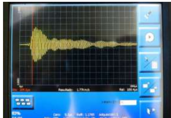
Figura 30: Comportamiento presentado por la onda en pantalla para el palpador de 24 KHz con una ganancia de 1 sobre el patrón 5 en los puntos (62.5, 10) y (62.5, 40). Zona de material con presencia de defectología inducida correspondiente a la segregación
