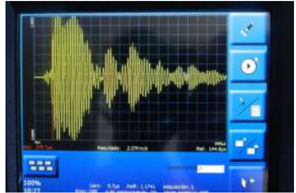
Figura 60: Comportamiento presentado por la onda en pantalla para el palpador de 24 KHz con una ganancia de 1 sobre el patrón 4 en los puntos (40,17.5) y (40,17.5). Zona de material uniforme.
