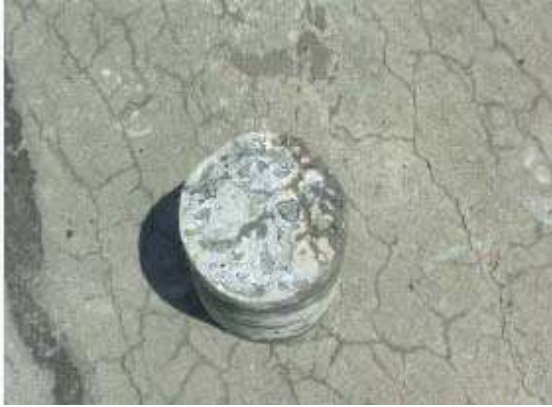
Figura 22: Reacción álcali agregado. Jornada de actualización técnica "Diseño y Construcción de pavimentos de Hormigón" Ing. Diego H. Calo, 20 de noviembre de 2008.
