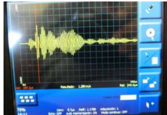
Figura 42 Comportamiento presentado por la onda en pantalla para el palpador de 24 KHz con una ganancia de 1 sobre el patrón 6 en los puntos (65, 5) y (95, 5). Zona que presenta discontinuidades o defectología de acuerdo con el dato de variación de velocidad, más la gráfica muestra un comportamiento con características presentes en zonas sin discontinuidades.
