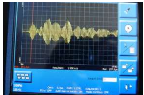
Figura 62: Comportamiento presentado por la onda en pantalla para el palpador de 24 KHz con una ganancia de 1 sobre el patrón 7 en los puntos (65,35) y (65,35). Zona de material con presencia de defectología inducida correspondiente a la simulación de grietas.
