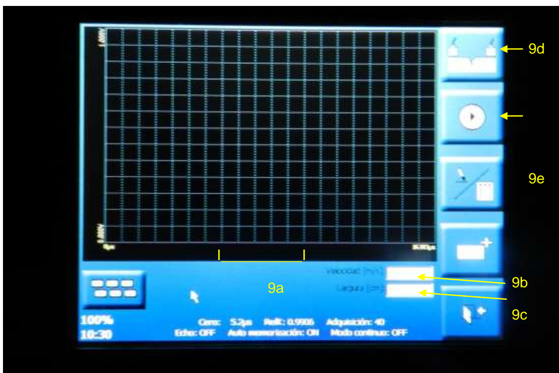
Figura 9: Pantalla de medición de la profundidad de la grieta (indicada en el botón 9d).
