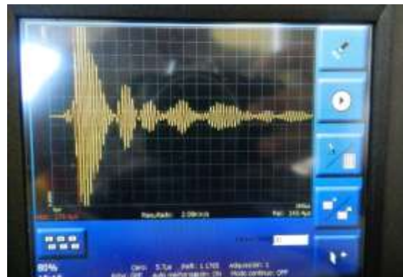
Figura 36: Comportamiento presentado por la onda en pantalla para el palpador de 24 KHz con una ganancia de 1 sobre el patrón 6 en los puntos (5, 50) y (35, .50). Zona de material uniforme.
