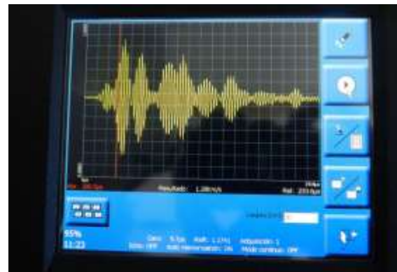
Figura 12: Comportamiento presentado por la onda en pantalla para el palpador de 24 KHz con una ganancia de 1 sobre el patrón 2 en los puntos (5,5) y (35,5). Zona de material con presencia de defectología.
