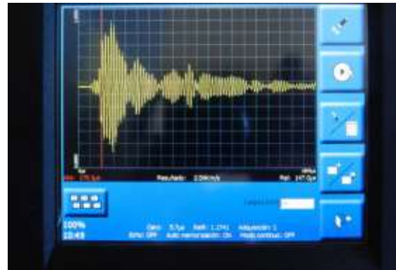
Figura 6: Comportamiento presentado por la onda en pantalla para el palpador de 24 KHz con una ganancia de 1 sobre el patrón 6 en los puntos (35,35) y (65,35). Zona de material uniforme.
