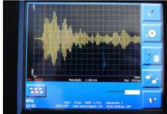
Figura 17: Comportamiento presentado por la onda en pantalla para el palpador de 24 KHz con una ganancia de 1 sobre el patrón 1 en los puntos (5,25) y (35,25). Zona de material uniforme.
