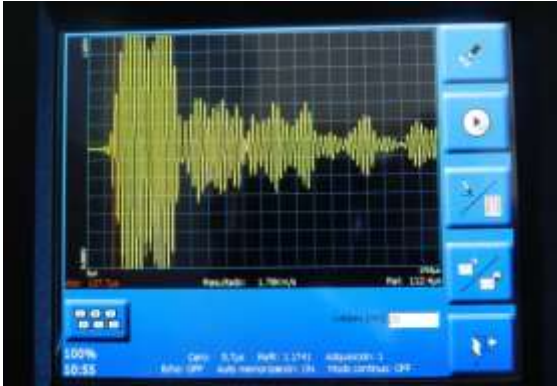
Figura 8: Comportamiento presentado por la onda en pantalla para el palpador de 24 KHz con una ganancia de 1 sobre el patrón 2 en los puntos (5,5) y (5,25). Zona de material con presencia de defectología.
