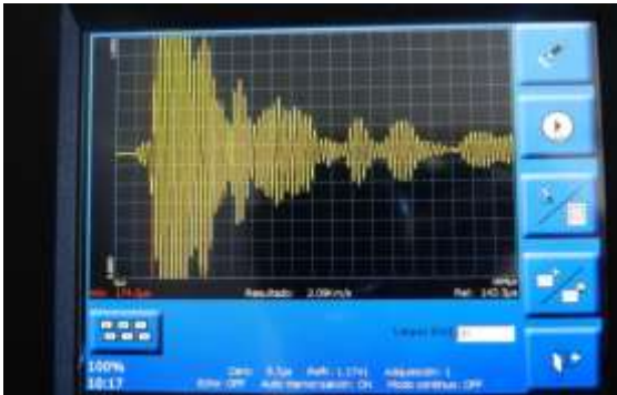
Figura 3: Comportamiento presentado por la onda en pantalla para el palpador de 24 KHz con una ganancia de 1 sobre el patrón 2 en los puntos (5,15) y (35,15). Zona de material uniforme.
