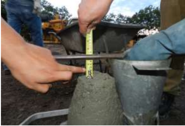
Figura 37: Ensayo de trabajabilidad del material por utilizar acorde con la norma ASTM C143.
