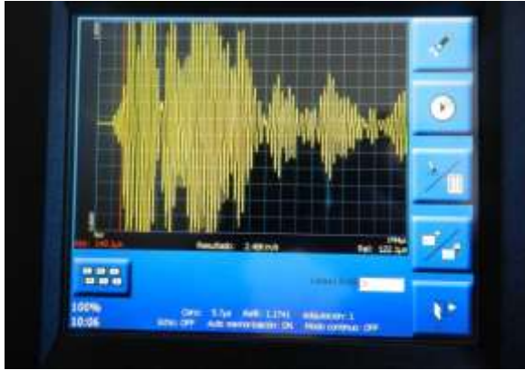
Figura 57: Comportamiento presentado por la onda en pantalla para el palpador de 24 KHz con una ganancia de 1 sobre el patrón 1 en los puntos (35, 5) y (5,15). Zona de material uniforme.
