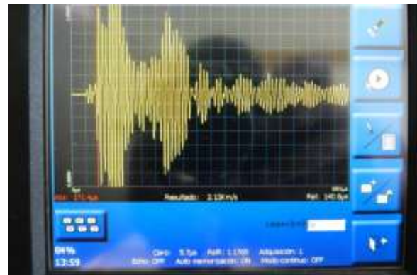
Figura 70: Comportamiento presentado por la onda en pantalla para el palpador de 24 KHz con una ganancia de 1 sobre el patrón 4 en los puntos (10,2.5) y (10,32.5). Zona de material uniforme.
