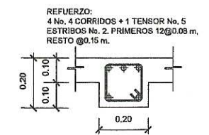
CORTE C DETALLE DE VIGA SIN ESCALA
