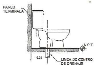
SECCION A-A' (INSTALACION DE DRENAJE SANITARIO) ESC. 1/20
