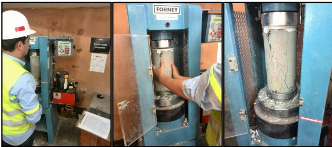
Figura 17. Ensayo a compresión de cilindros de concreto
