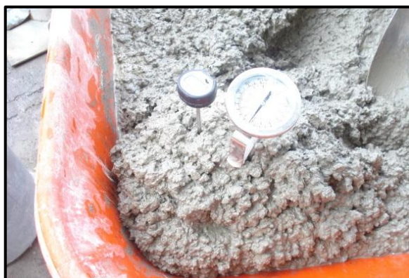
Figura 15. Ensayo de temperatura a concreto fresco
