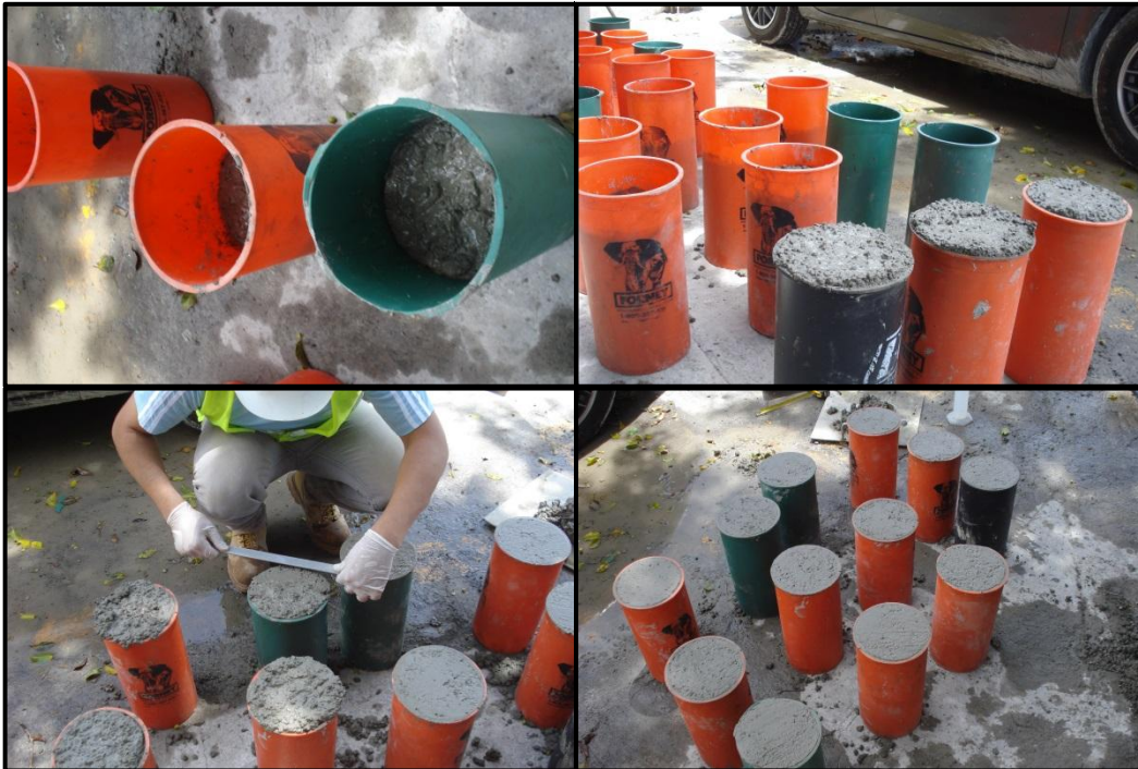
Figura 10. Elaboración de testigos de concreto para ensayos
