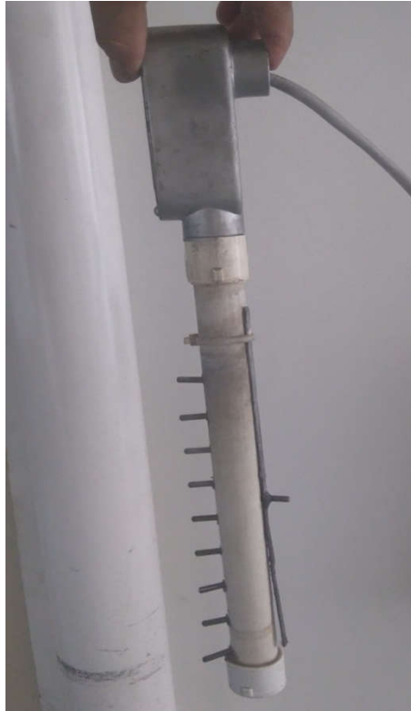
Figura 16. Electrodos de nivel de sensor de nivel de río
