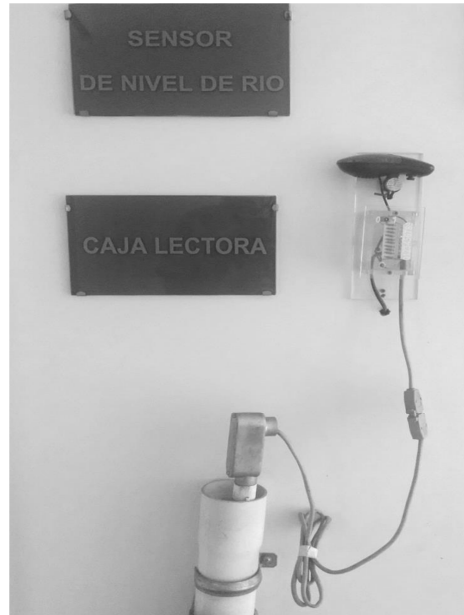
Figura 14. Prototipo de sensor de nivel de río
