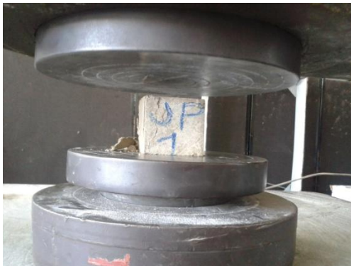
c. Ensayo a compresión
