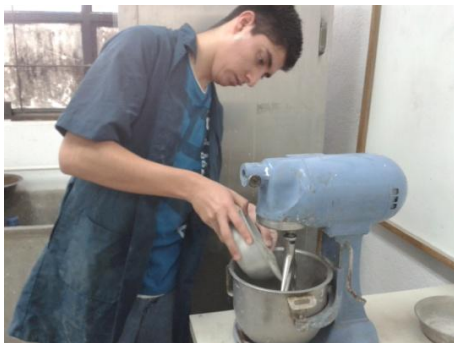
a. Colocación del mortero y agua
