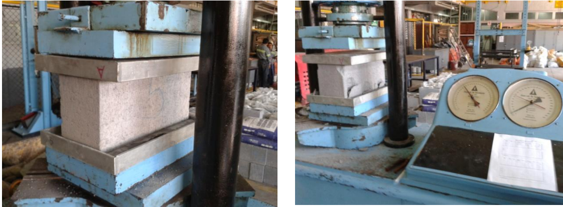
Figura 11. Ensayo a compresión de blocks
