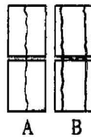
7) Separación de pared externa de unidad
