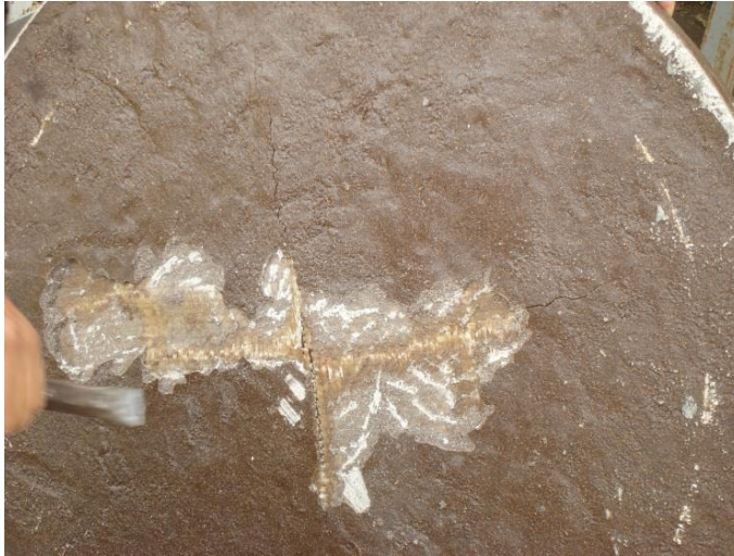
Figura 31. Tapadera, bajo el eje neutro
