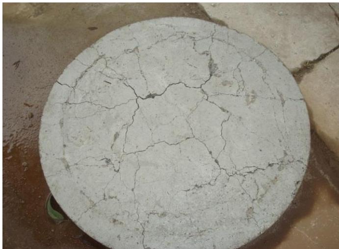
Figura 25. Tapadera de concreto normal después del ensayo
