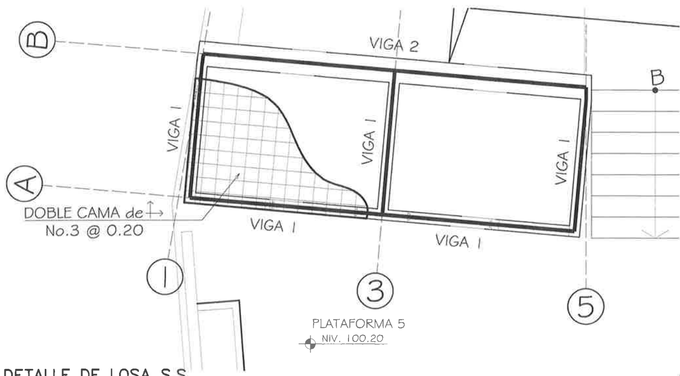
DETALLE DE LOSA S.S.
