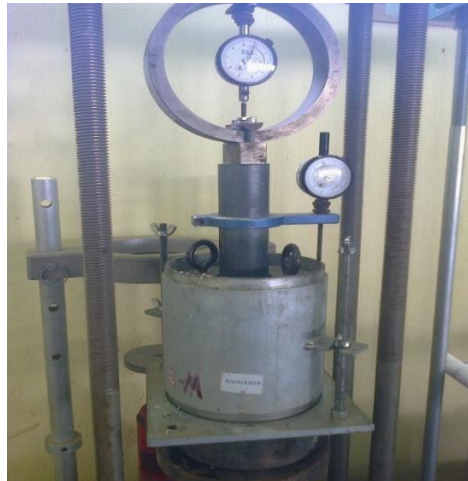
Figura 9. Fase de penetración de ensayo CBR
