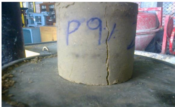
Figura 18. Falla de una probeta de arena limosa color beige rosa estabilizada con cemento prehidratado
