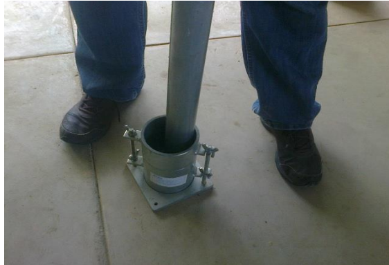
Figura 8. Ensayo Proctor Modificado
