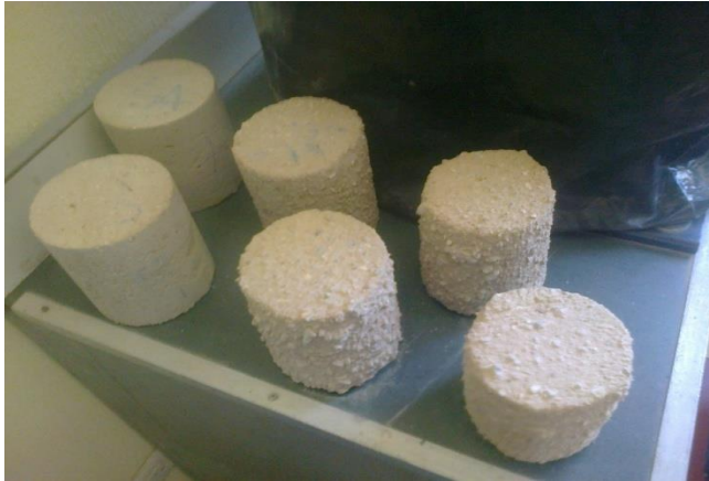
Figura 15. Probetas de suelo cemento al finalizar el ensayo de humedecimiento y secado
