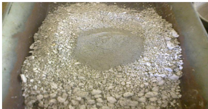
Figura 14. Suelo estabilizado con cemento anhidro
