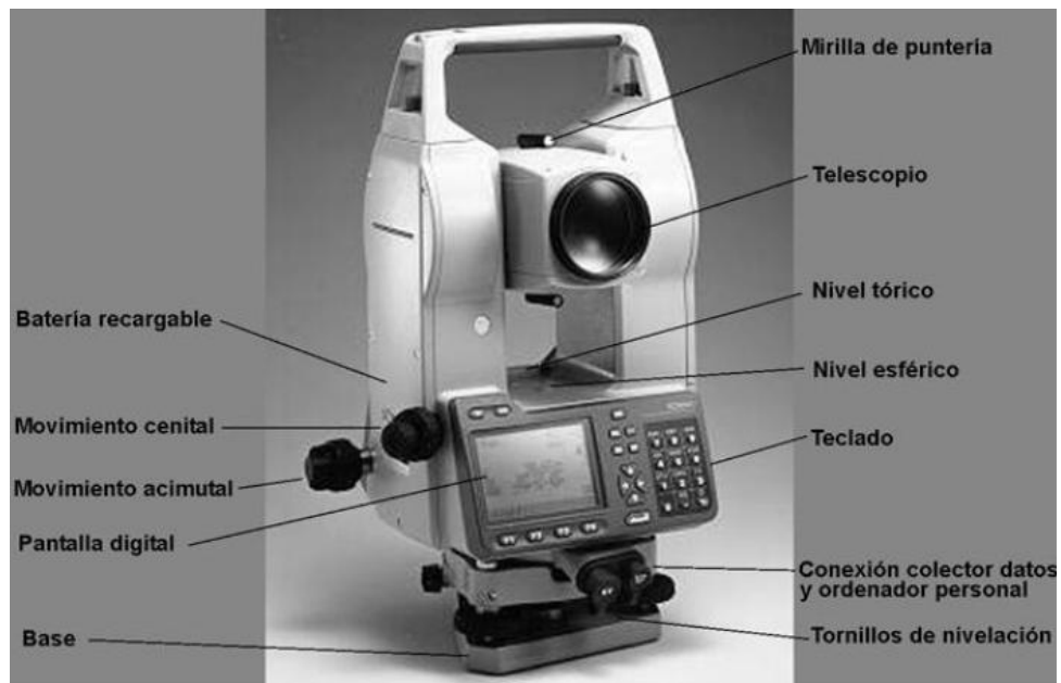
Figura 5. Partes fundamentales de una estación total
