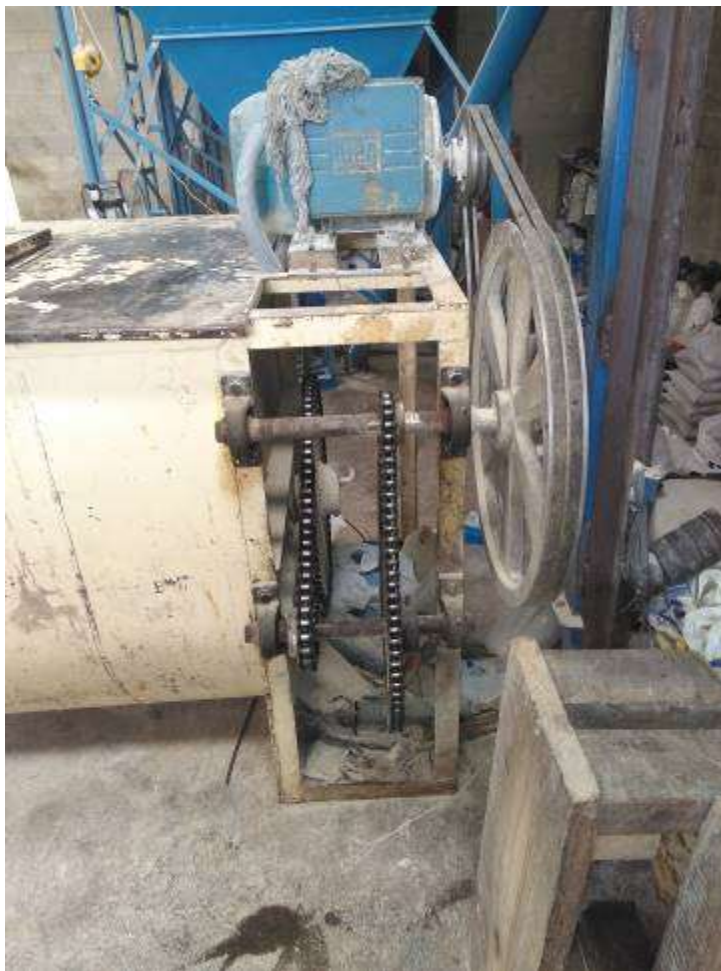
Figura 12. Mezcladora y mecanismo de acción
