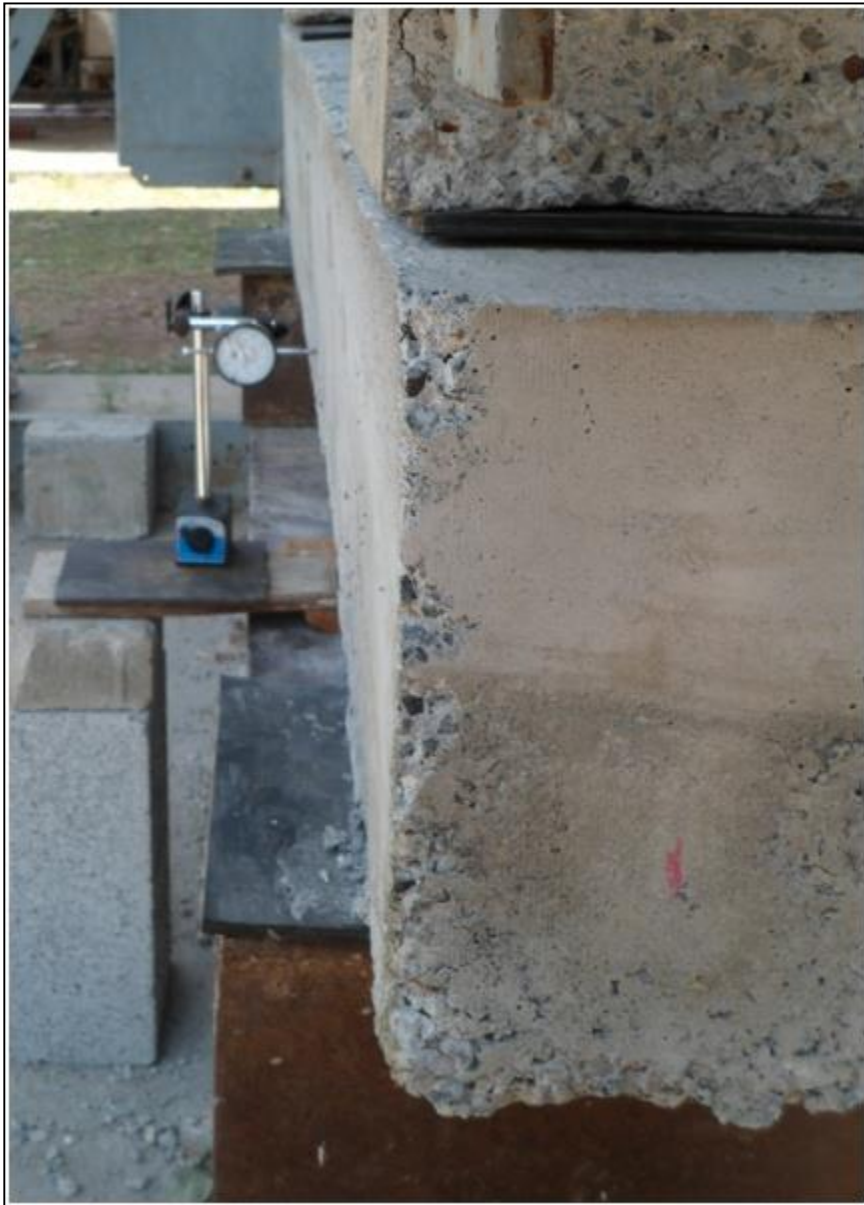
Figura 72. Deformación del elemento 2
