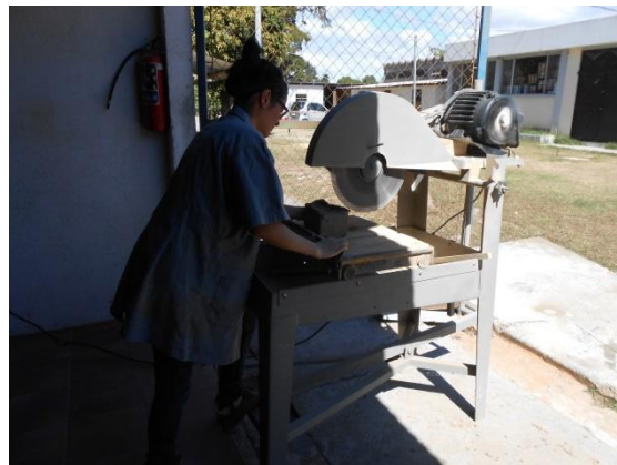
Figura 9. Labrado de cubos con sierra eléctrica
