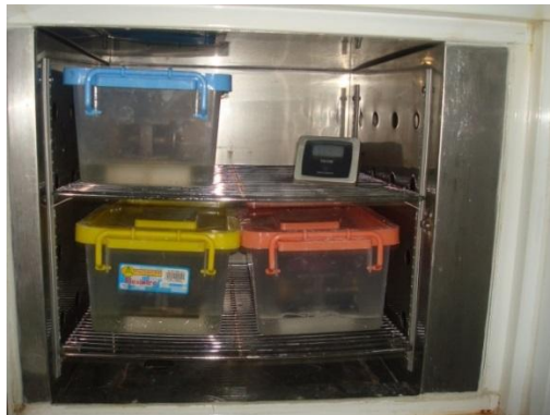
Figura 7. Muestras colocadas en cámara de vapor
