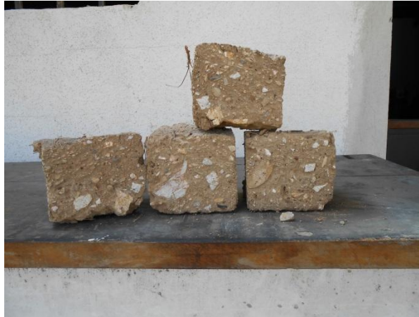
Figura 10. Cubos labrados para ensayos a compresión
