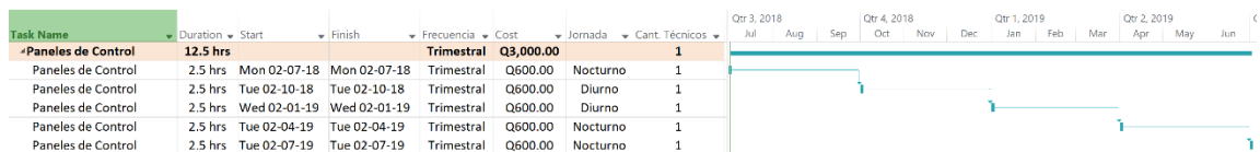
Figura 73. Propuesta del plan de mantenimiento preventivo eléctrico: panel de control – horno Ecotherm
