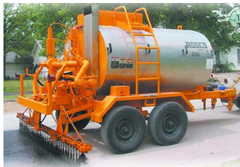
Figura 32. Petrolizadora remolcable, Rosco RMT-1000
