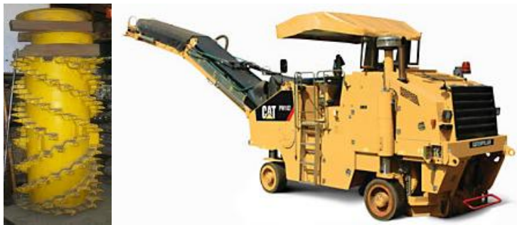
Figura 27. Máquina fresadora de asfalto en frío, CAT PM 102 Wheel
