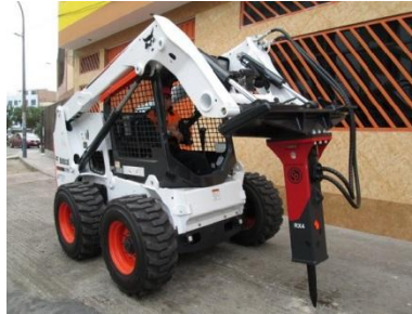
Figura 43. Martillo hidráulico, Chicago Pneumatic RX4, colocado en un minicargador BobCat S185
