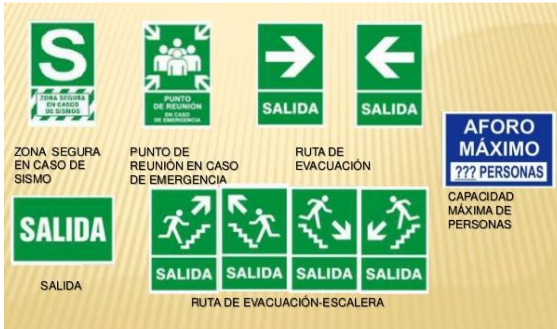
Figura 21. Señalización de ruta de evacuación
