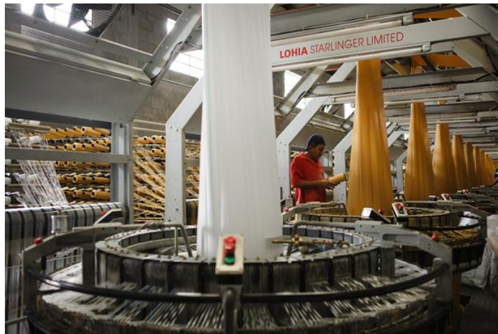
Figura 15. Telar tubular del área de sacos
