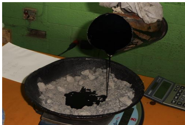
Figura 14. Mezclado de agregado y cemento asfáltico
