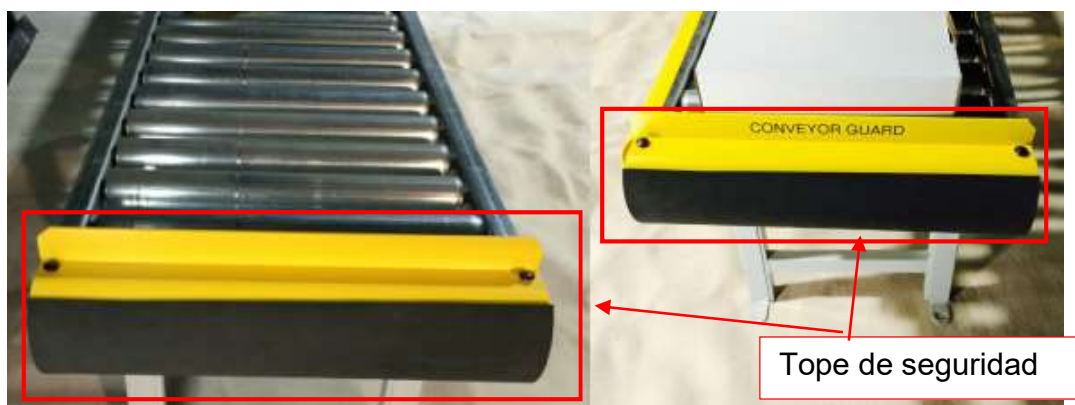
Figura 29. Equipo de seguridad para banda transportadora
