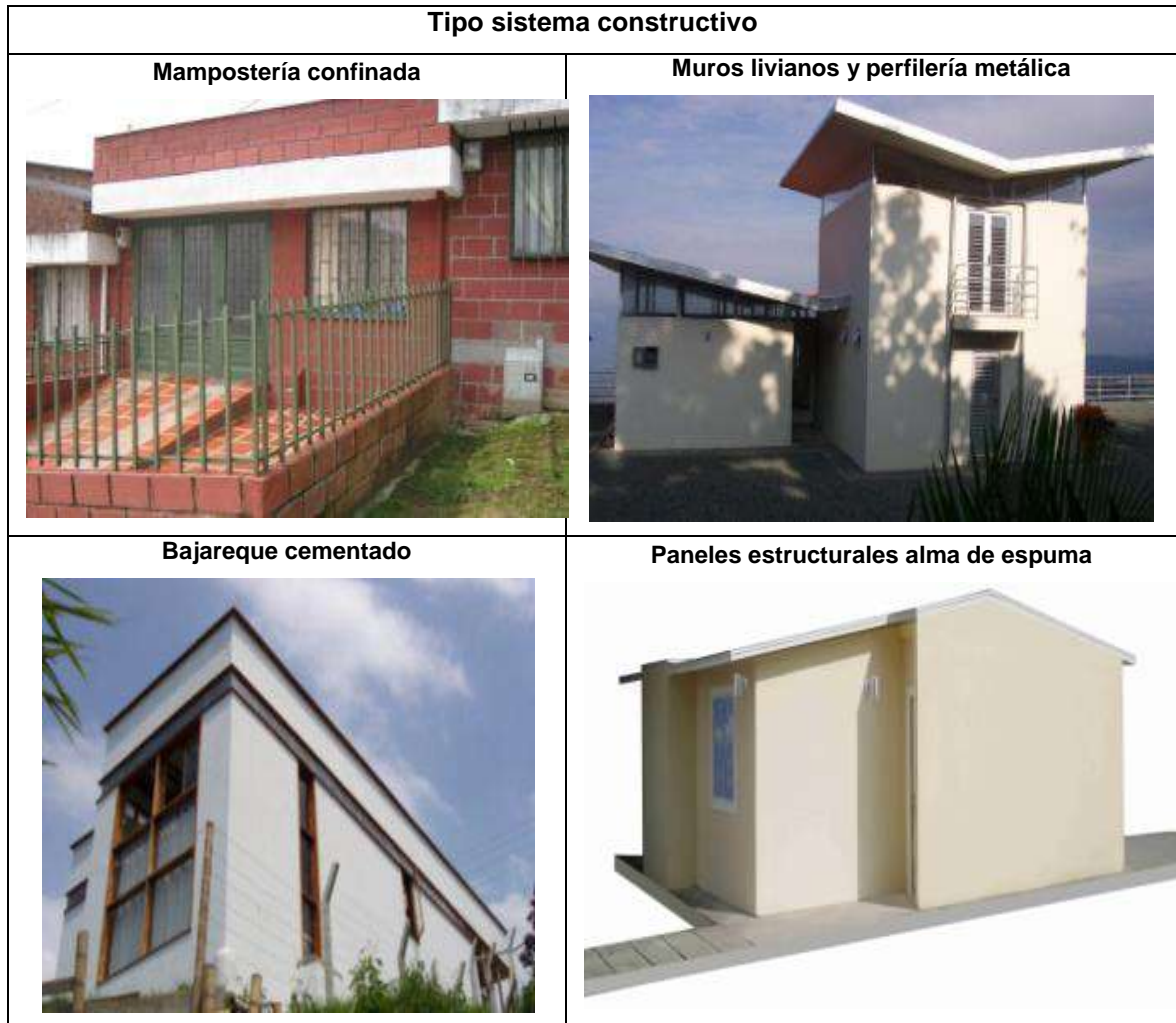
Figura 2. Sistemas constructivos de vivienda
