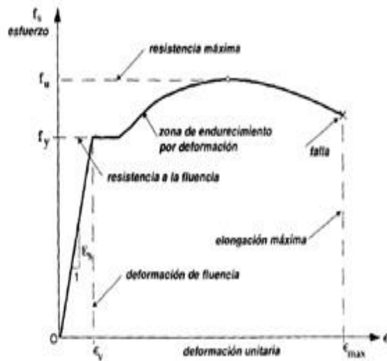
(a) Diagrama esfuerzo-deformación del acero de refuerzo
