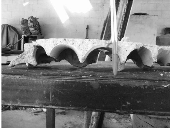
Figura 22. Efecto dovela del mortero envolviendo botellas PET
