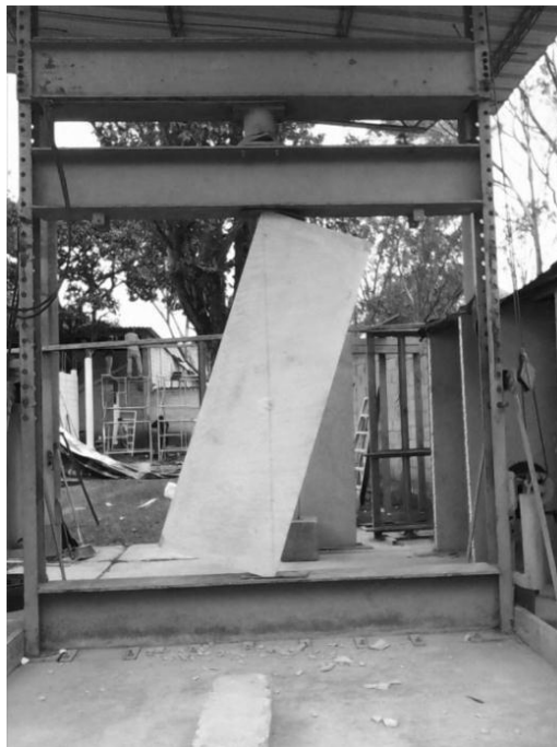
Figura 33. Prueba a corte de panel ecológico
