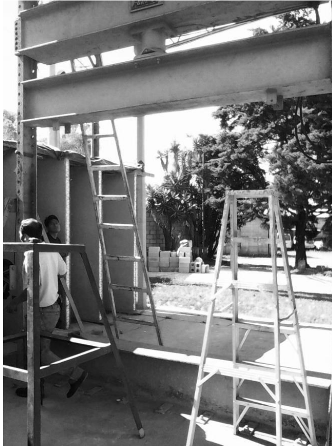
Figura 17. Prensa hidráulica de 150 000 libras
