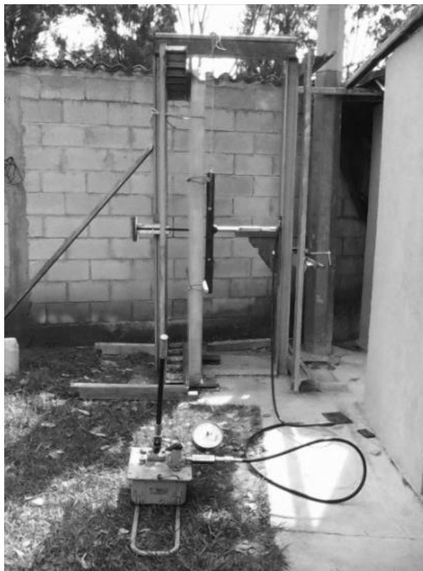
Figura 29. Prueba a flexión vertical de panel ecológico
