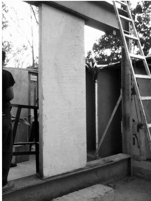
Figura 11. Relación de esbeltez de panel ecológico h/e= 24 \geq 20
