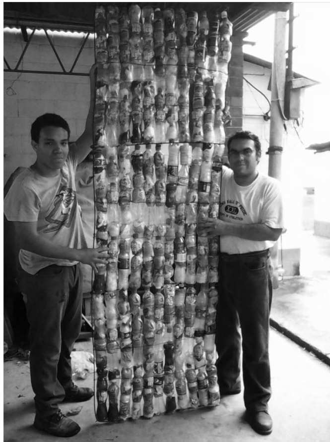
Figura 1. Panel ecológico de botellas tipo PET
