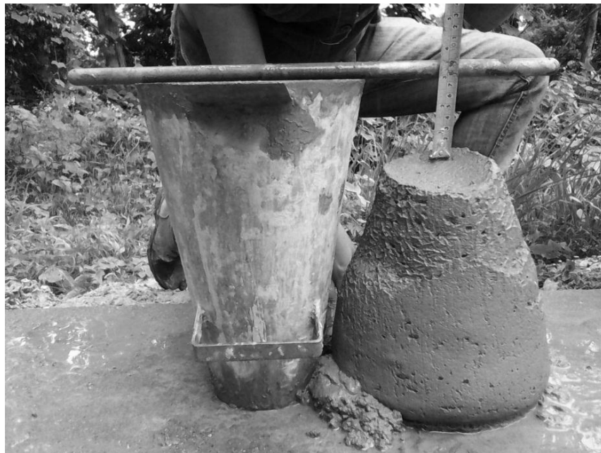
Figura 27. Resultado de la prueba de Revenimiento de 3,5”
