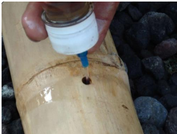
Figura 4. Tratamiento de diesel a culmos de bambú de la especie Dendrocalamus Asper
